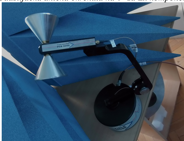
Sl. 4.4. Odašiljačka antena okrenuta na 240° za Ez komponentu polja.
