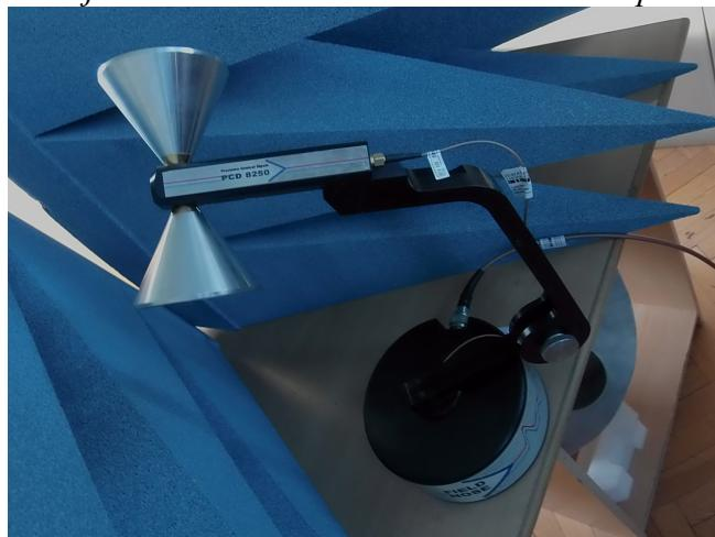
Sl. 4.4. Odašiljačka antena okrenuta na  $240^\circ$  za Ez komponentu polja.
