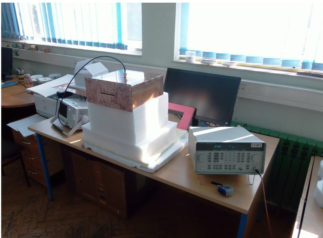
Sl. 4.7. Mjerenje djelotvornosti oklapanja za prvo kućište.
