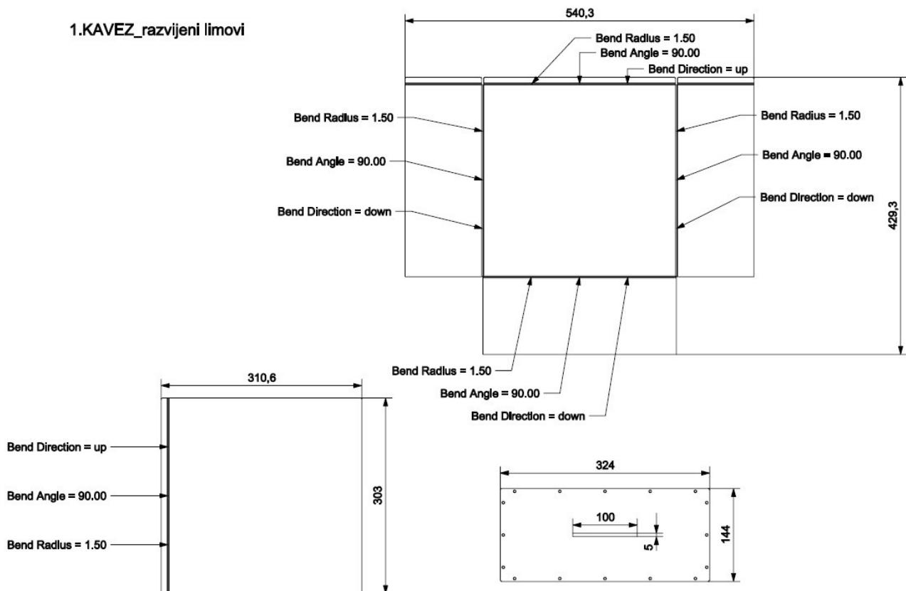
Sl. 3.1. Prikaz razvijenih limova i parametri savijanja.
