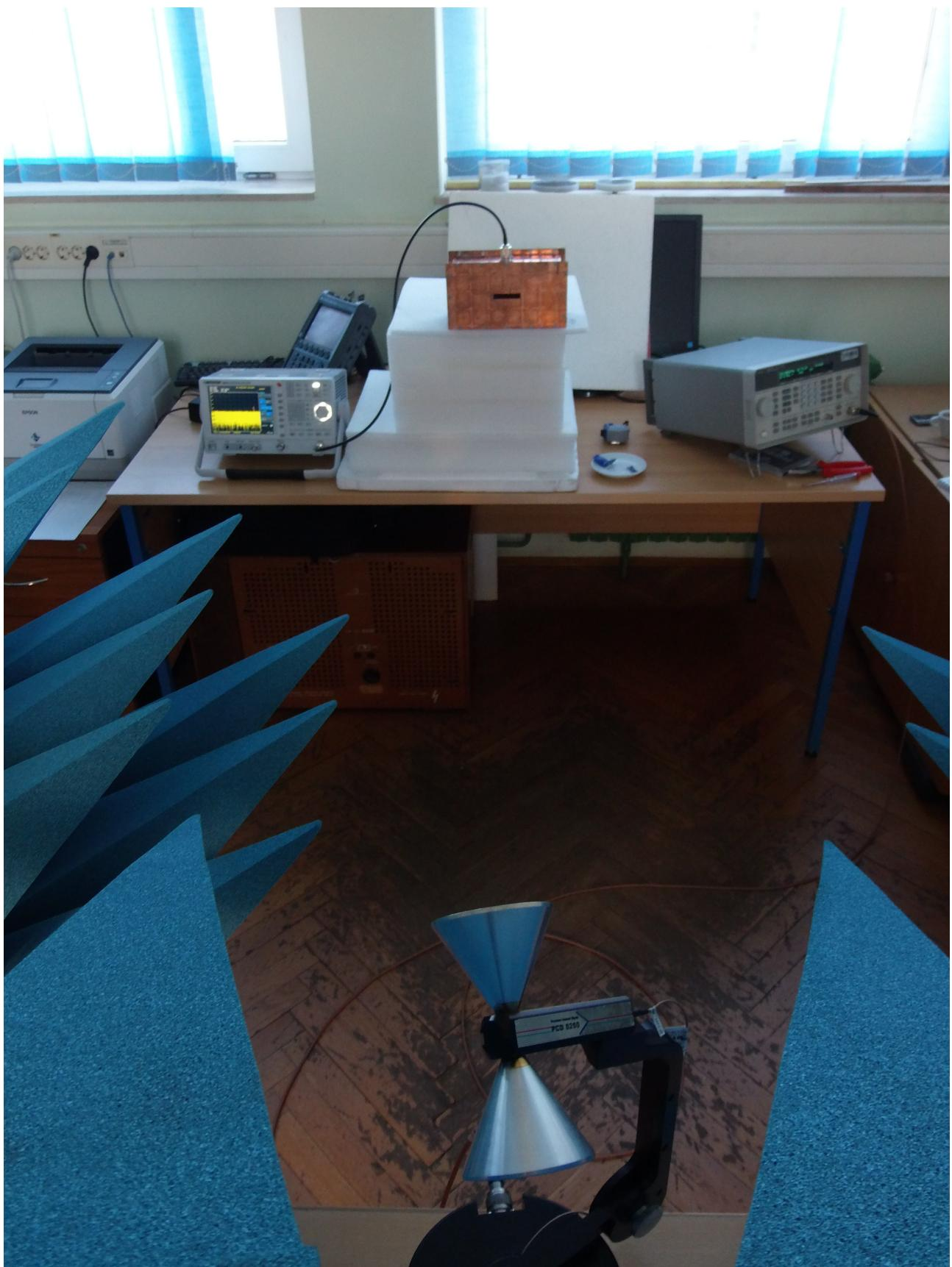
Sl. 4.13. Mjerenje djelotvornosti oklapanja drugog kućišta.
