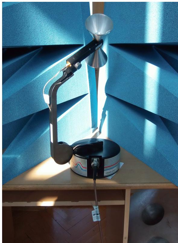
Sl. 4.3. Odašiljačka antena okrenuta na  $0^\circ$  za Ex komponentu polja.
