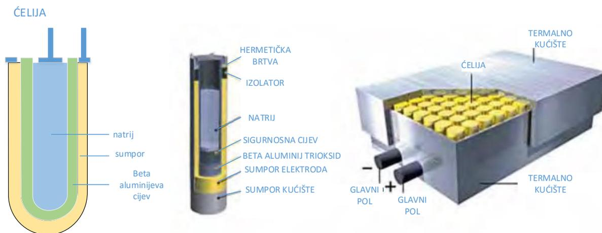
**Slika 3.7** NaS baterija: Dizajn ćelije i 50kW modul [3]
