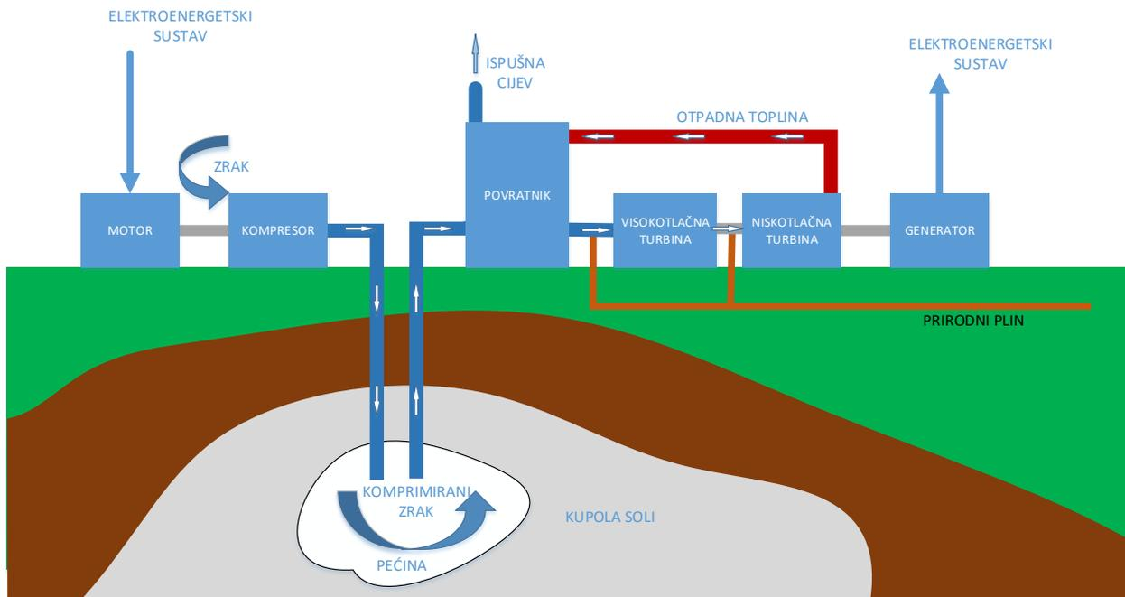
**Slika 3.4** Sustav pohrane energije komprimiranim zrakom [3]
