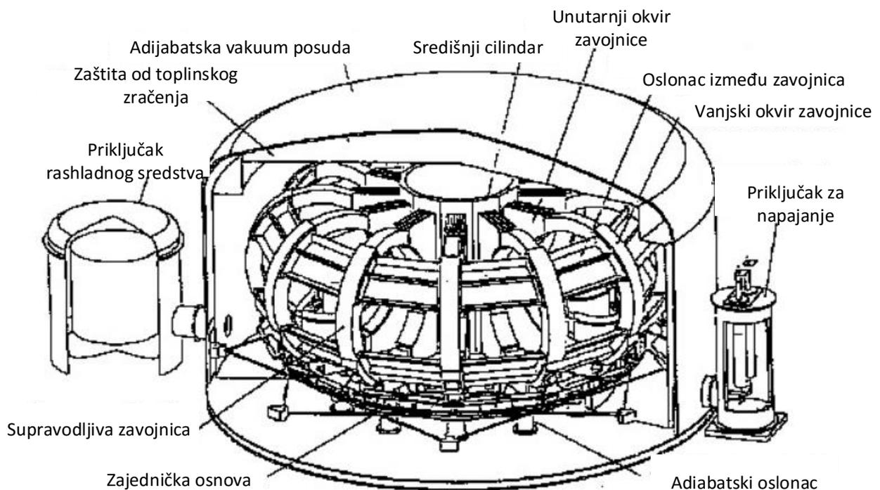
**Slika 3.13** Dijelovi supravodljivog magnetskog svitka [1]
