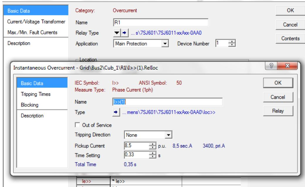
Slika 5.15. Parametri trenutnog nadstrujnog člana releja R<sub>1</sub>
