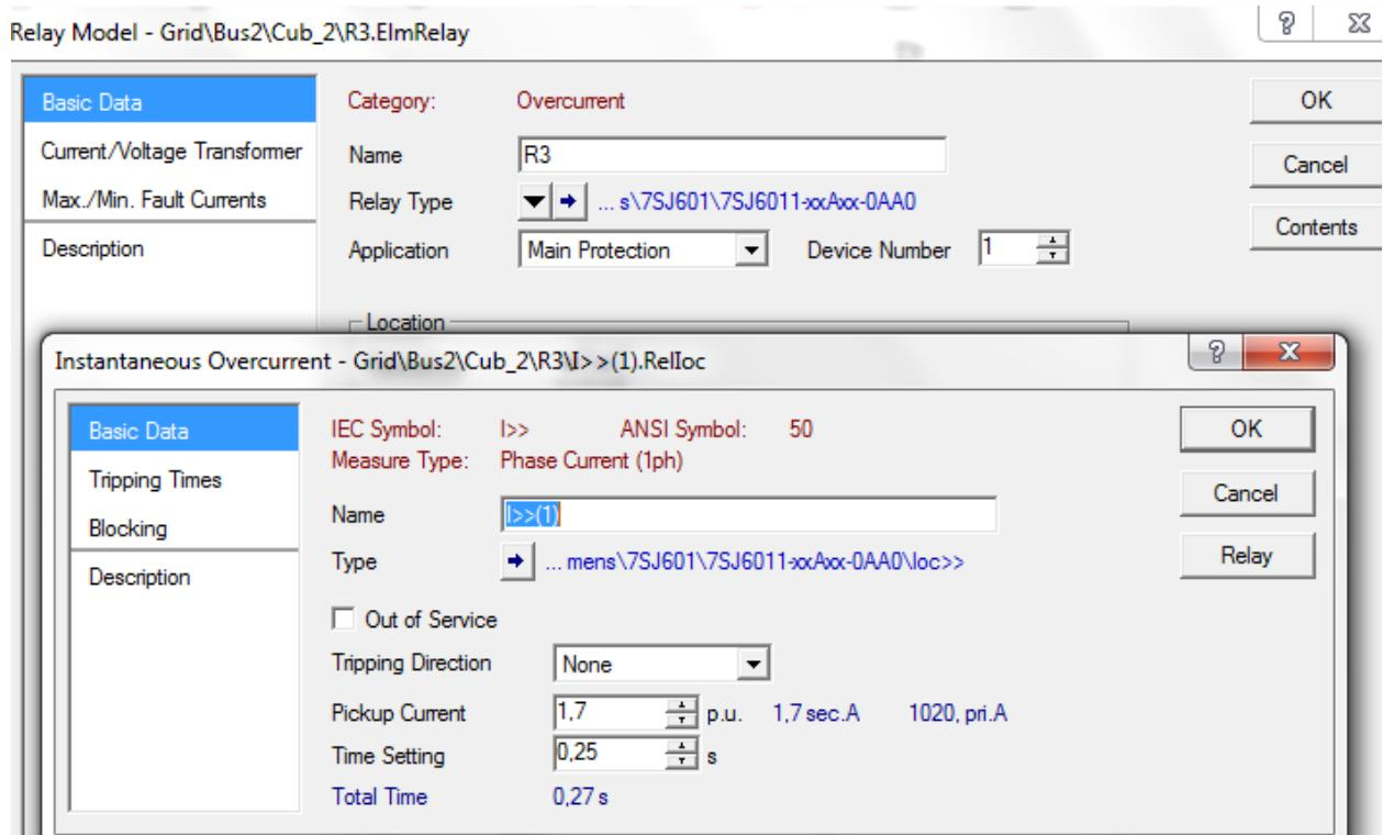
**Slika 5.17.** Parametri trenutnog nadstrujnog člana releja  $R_3$
