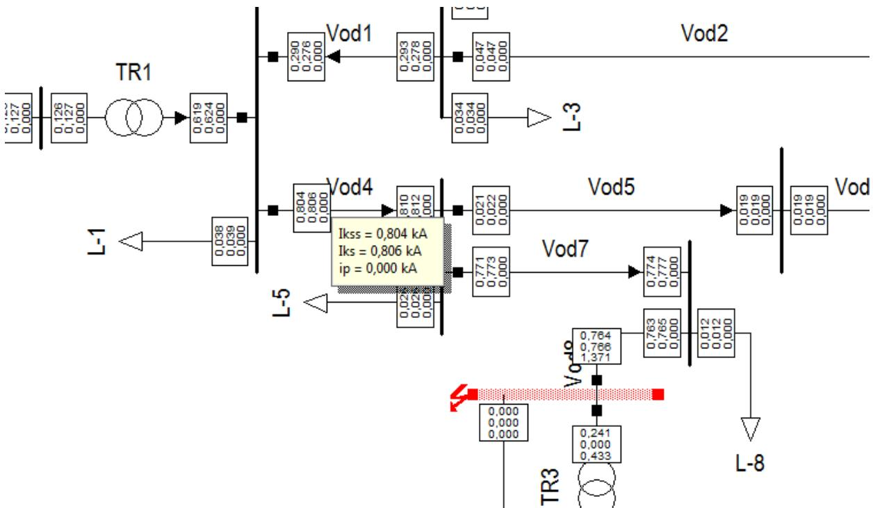
Slika 5.18. Kratki spoj na sabirnici Bus12 – parametrisiranje  $R_2$
