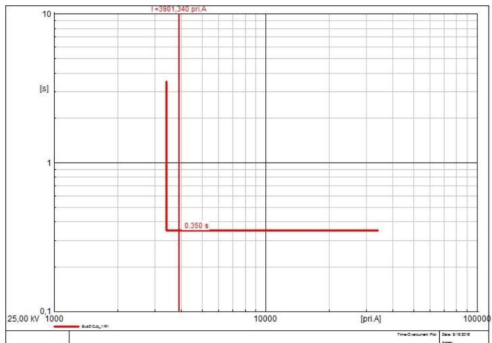
Slika 5.16. I-t karakteristika trenutnog nadstrujnog releja R<sub>1</sub>
