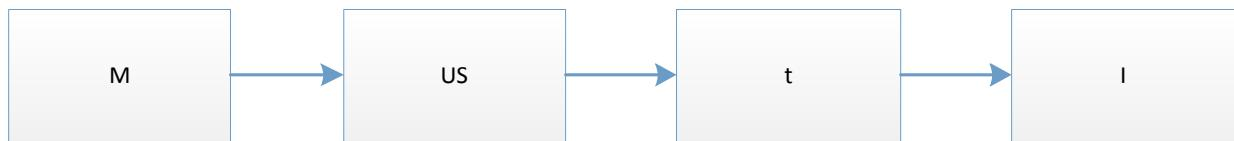
**Slika 4.2.** Blokovski prikaz sastava jednostavnog statickog releja
