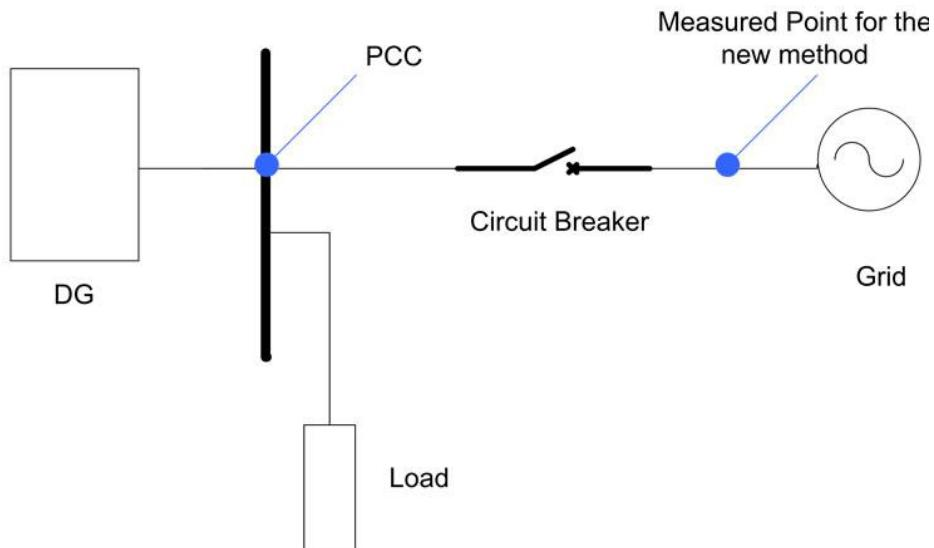
**Slika 2.10.** Jednopolna shema otočnog pogona [11]
