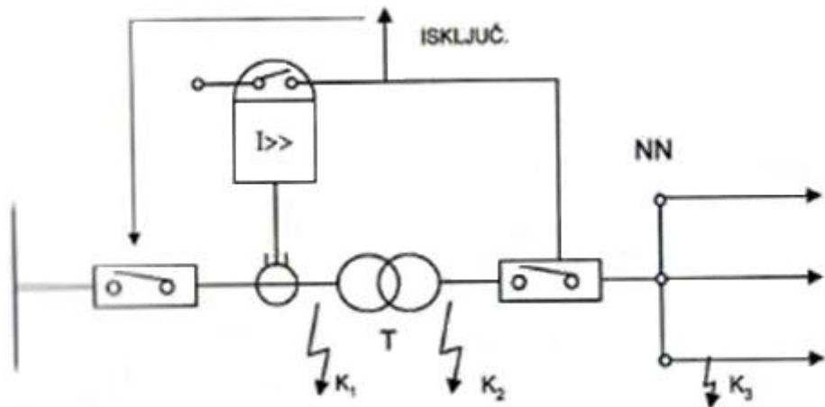
**Slika 4.12.** Shema trenutne nadstrujne zaštite transformatora [18]
