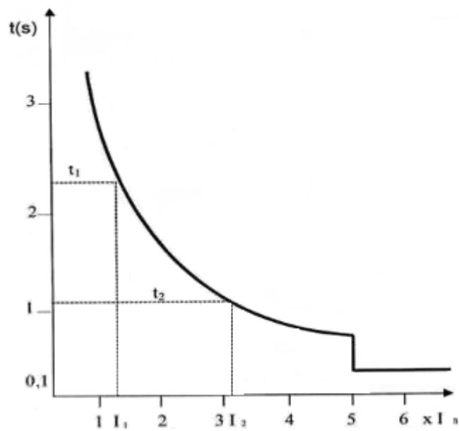
**Slika 4.9.** Kombinirana izvedba ovisnog i trenutnog nadstrujnog releja [18]
