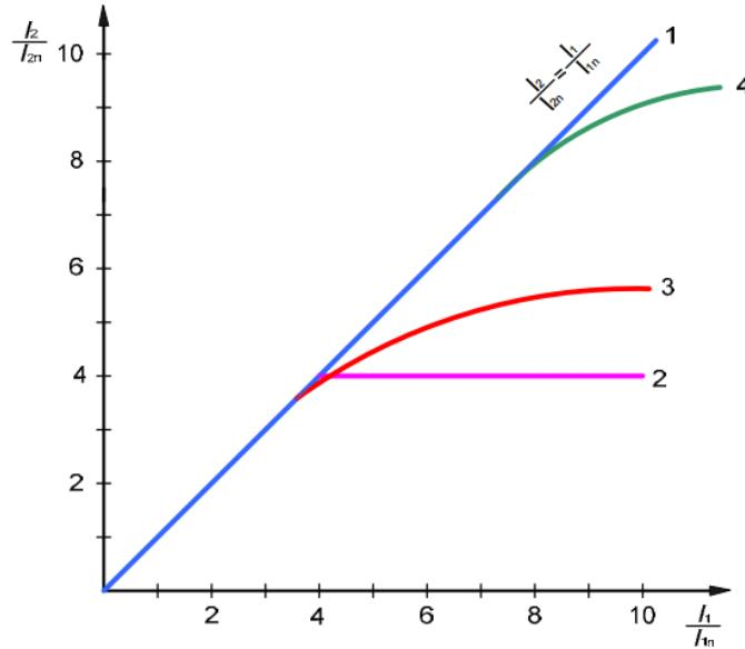
**Slika 4.4.** Strujna karakteristika transformatora [21]
