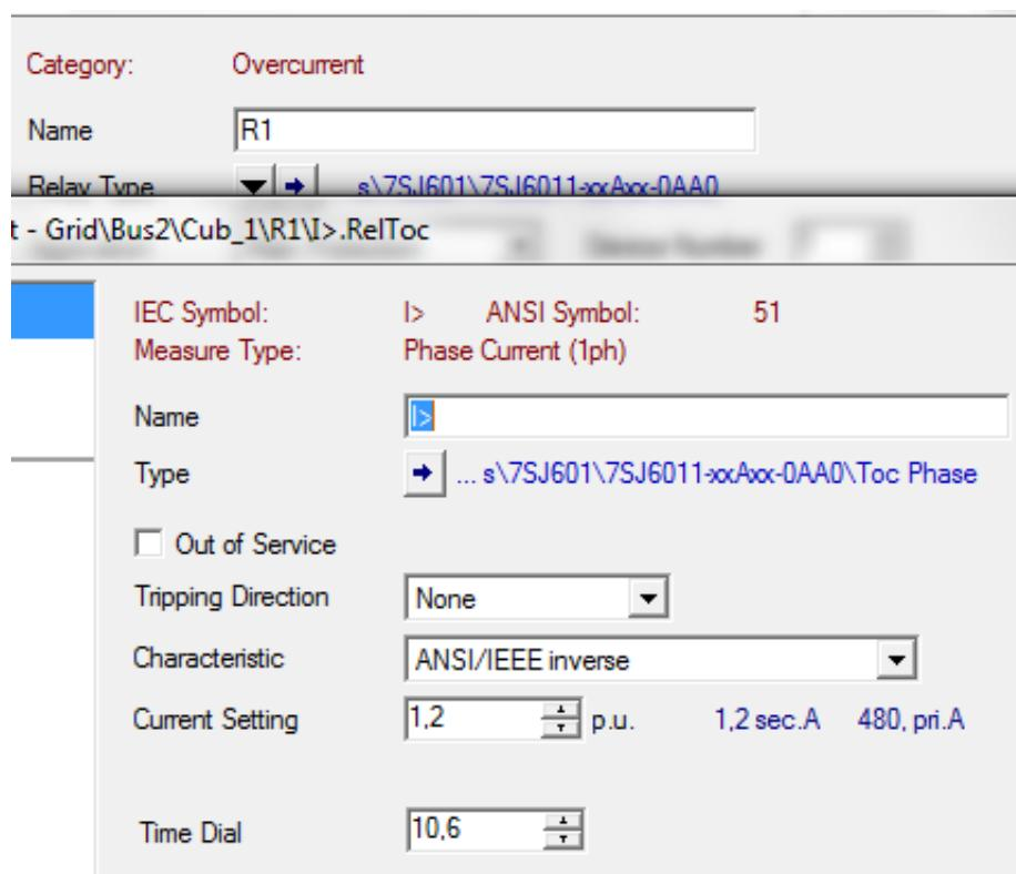
Slika 5.21. Parametri ovisnog nadstrujnog člana  $R_1$
