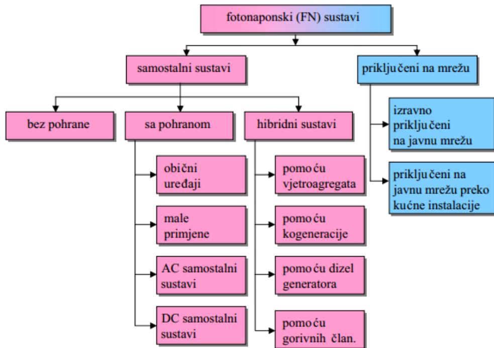
**Slika 2.12.** Podjela fotonaponskih sustava [14]
