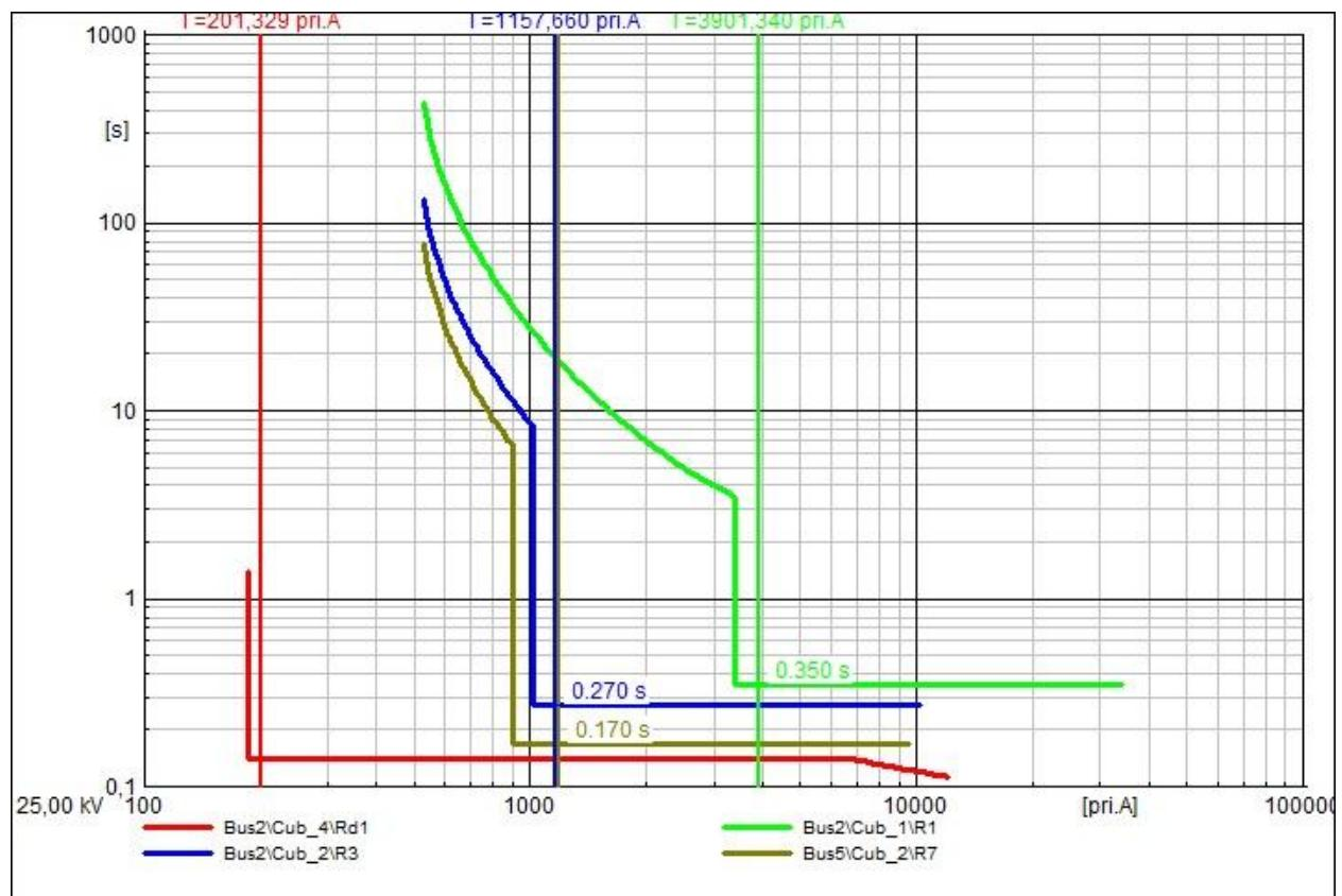
Slika 5.22. Koordinacija nadstrujnih zaštita – kratki spoj na sabirnici  $\text{Bus}_2$
