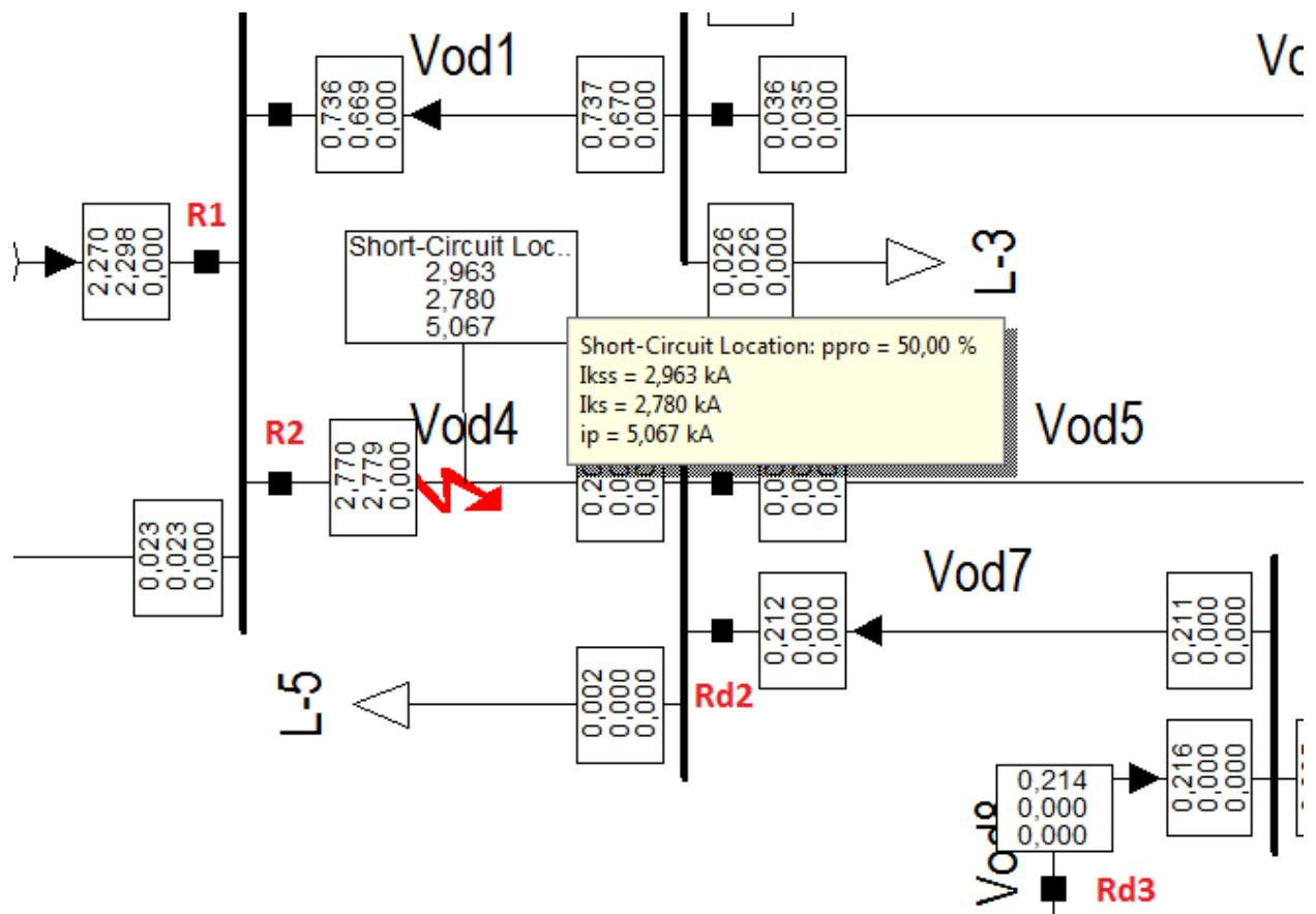
Slika 5.28. Kratki spoj na 50 % duljine kabela
