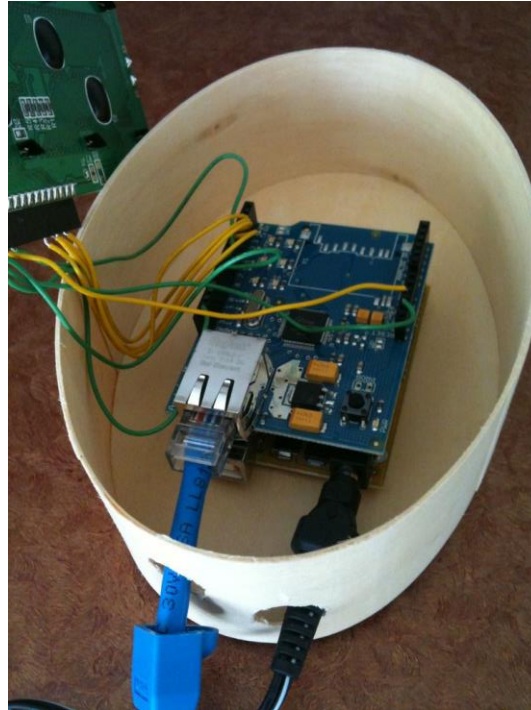
Sl. 4.2. Arduino Uno sa mrežnim modulom
