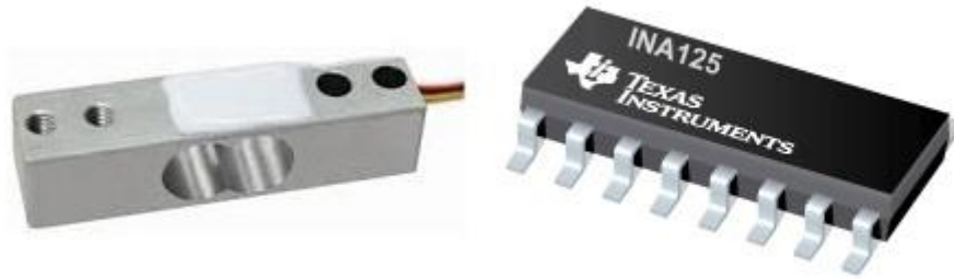
Slika 3.10. Load Cell i operacijsko pojačalo INA125 [20][21].
