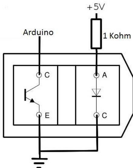
Slika 3.9. Shema spajanja senzora TCRT5000 na Arduino
