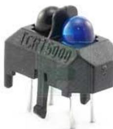
Slika 3.8. Optički senzor TCRT5000 [7].
