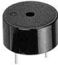
Slika 3.18. *Buzzer* (zujalica) [11].
