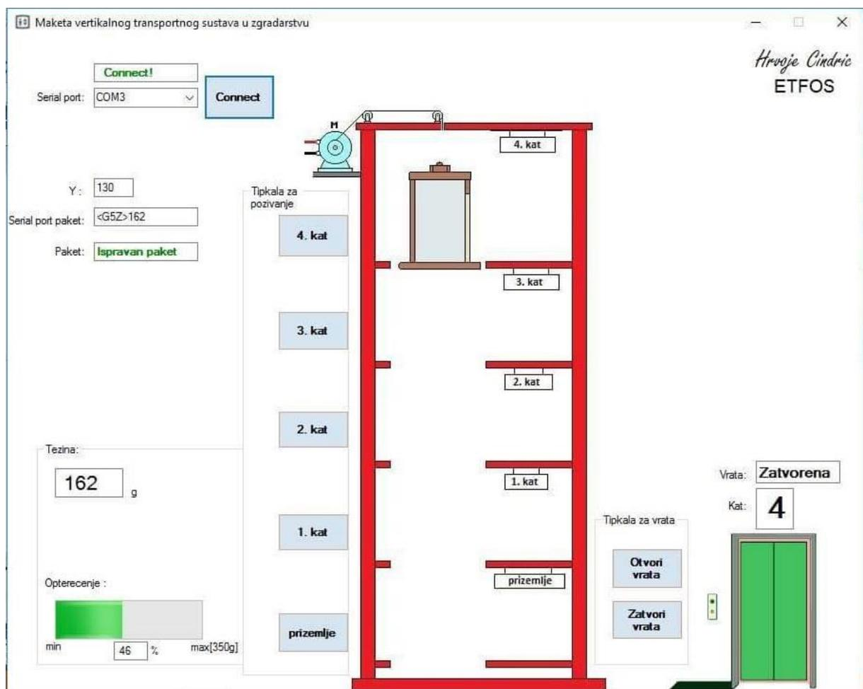
Slika 3.23. Sustav za udaljeni nadzor i kontrolu vertikalnog transportnog sustava.
