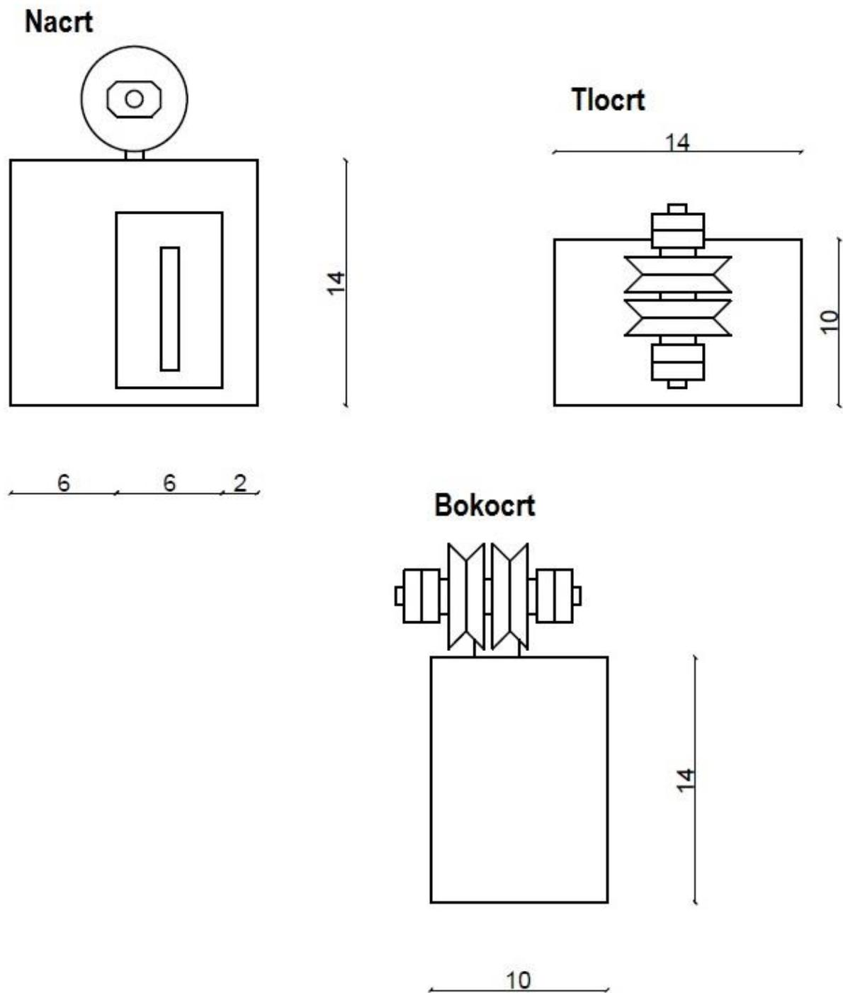
Slika 3.5. Nacrt, tlocrt i bokocrt kabine vertikalnog transportnog sustava.
