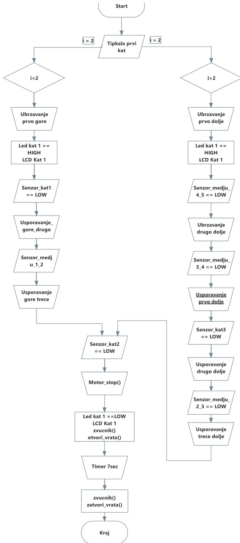
Slika 3.22. Algoritam pozivanja kabine vertikalnog sustava na 1. kat
