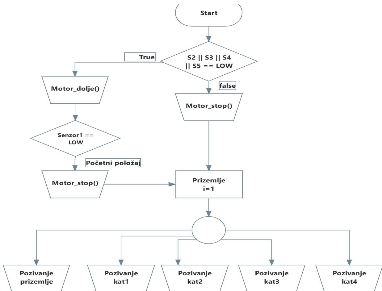
Slika 3.21. Glavni algoritam upravljanja vertikalnim transportnim sustavom
