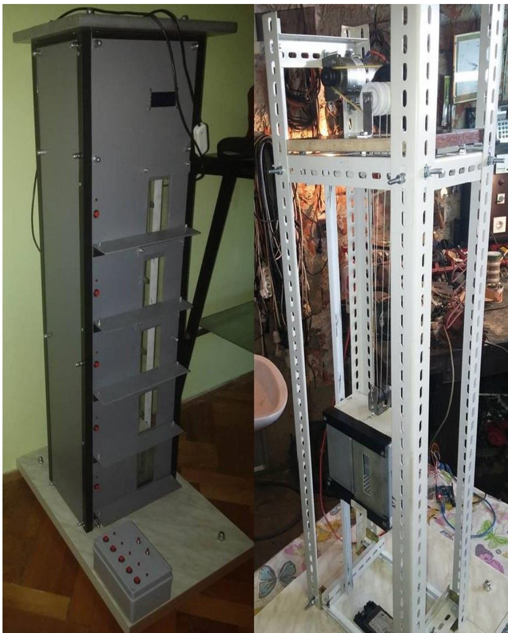
Slika 3.1. Maketa vertikalnog transportnog sustava za vrijeme izrade i nakon dovršetka.
