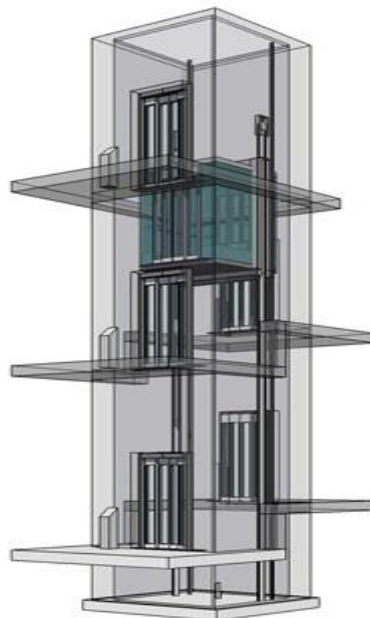
Slika 2.1. Modelski prikaz voznog okna vertikalnog transportnog sustava [4].
