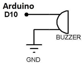
Slika 3.19. Shema spajanja *buzzera* na Arduino
