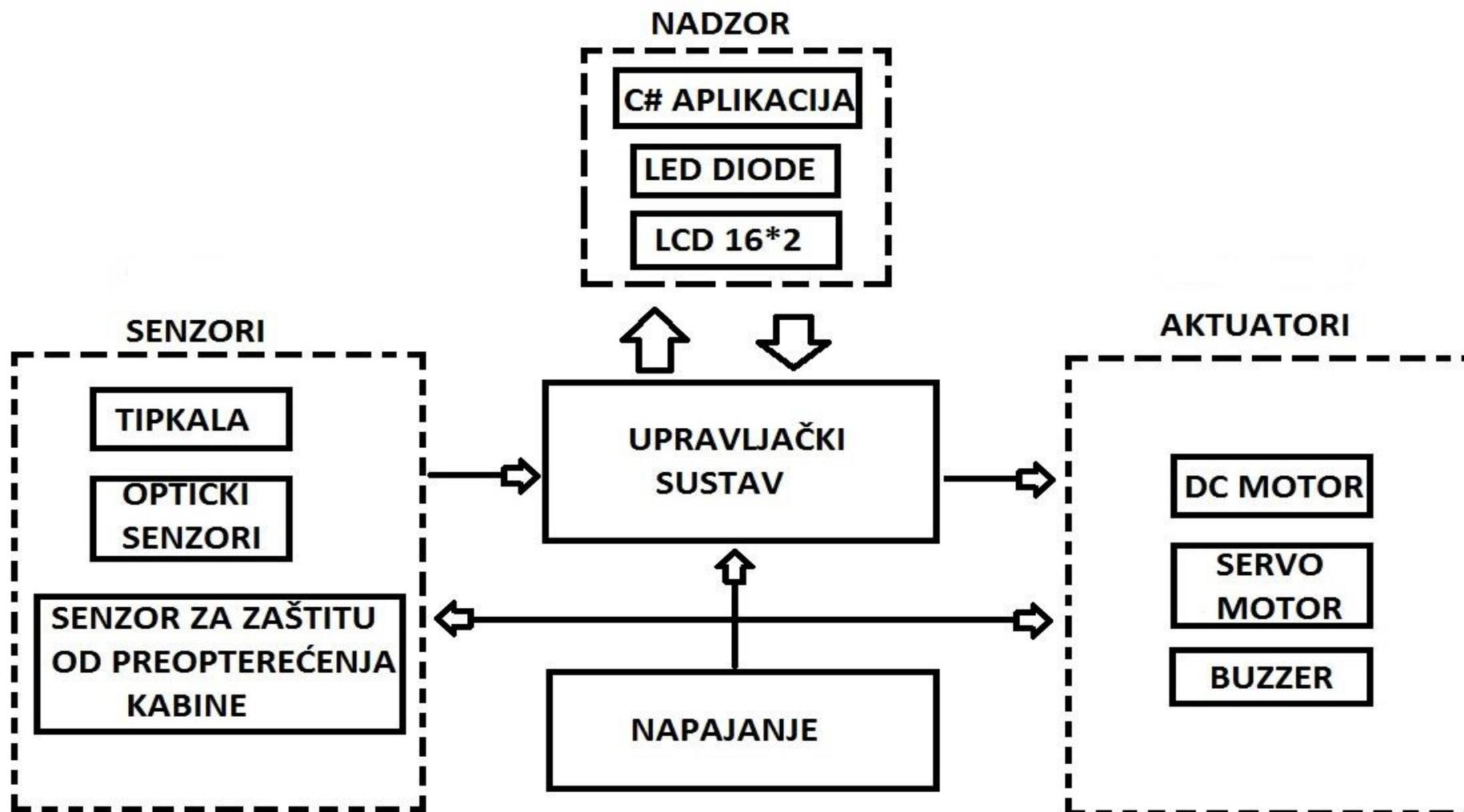
Slika 3.7. Funkcionalni blok dijagram vertikalnog transportnog sustava.
