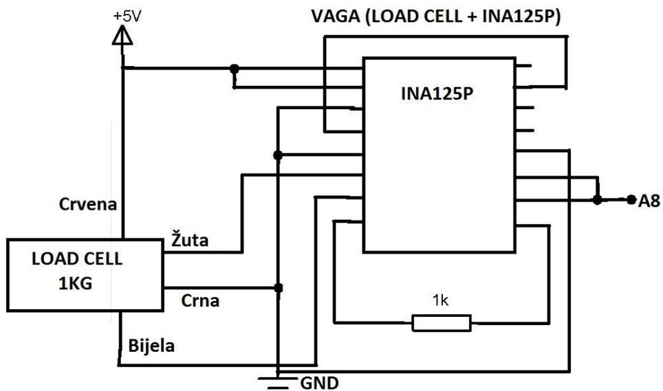
Slika 3.11. Shema spajanja sustava za zaštitu od preopterećenja kabine
