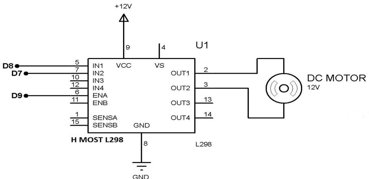
Slika 3.15. Shema spajanja DC motora na Arduino
