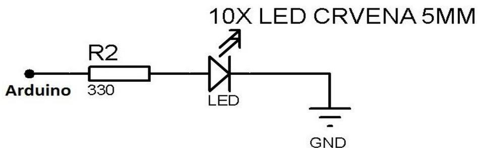
Slika 7.2. Shema spajanja led diode na Arduino.
