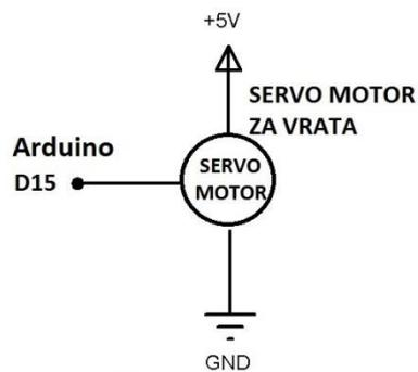
Slika 3.17. Shema spajanja servo motora na Arduino
