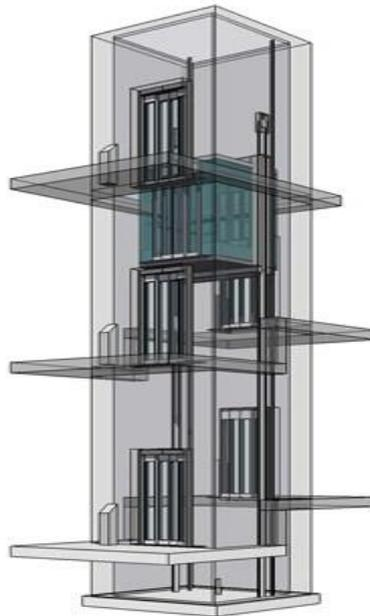
Slika 2.1. Modelski prikaz voznog okna vertikalnog transportnog sustava [4].
