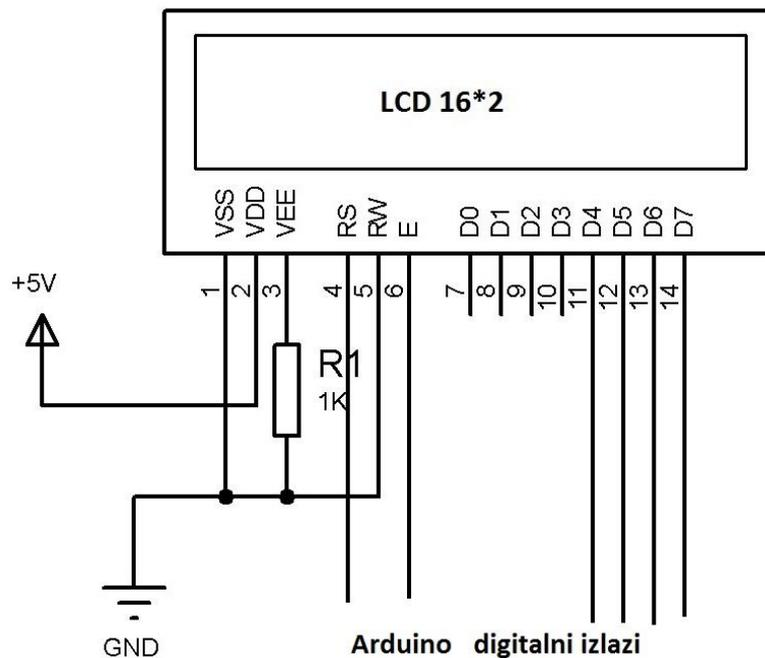
Slika 7.5. Shema spajanja lcd 16x2 na mikroupravljač
