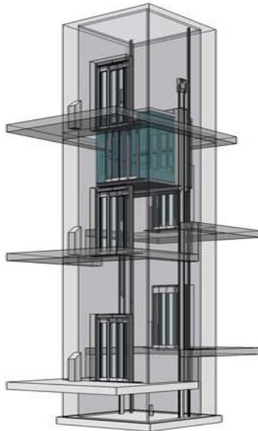
Slika 2.1. Modelska prikaz voznog okna vertikalnog transportnog sustava [4].
