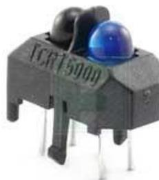
Slika 3.8. Optički senzor TCRT5000 [7].
