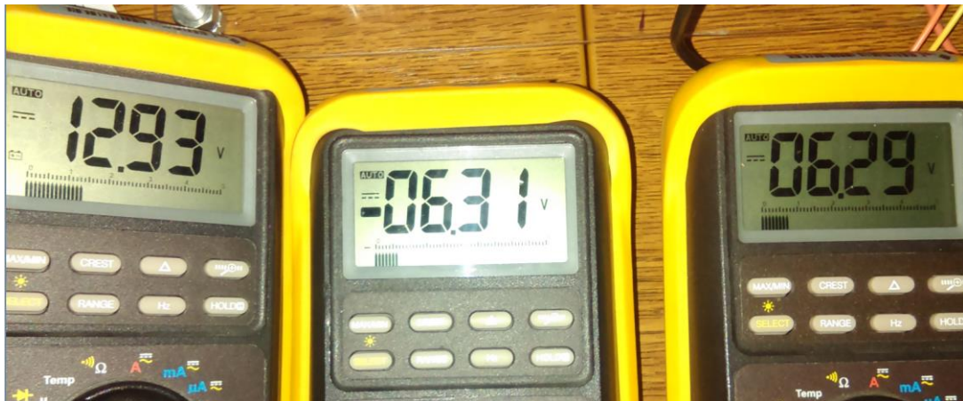
Slika 5.7. Srednje vrijednosti napona U_{GS} na P kanalnom MOSFET-u (negativno) i N kanalnom MOSFET-u (pozitivno) te ulazni napon.
