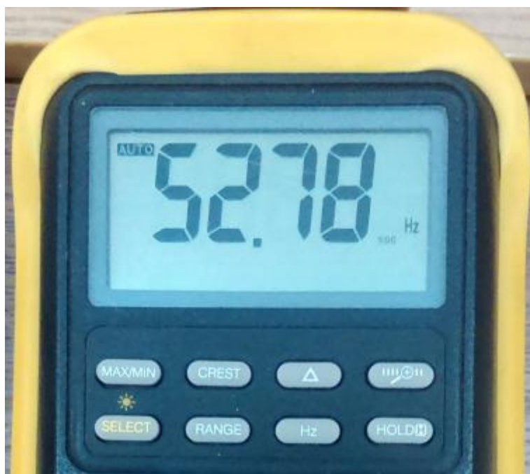
Slika 5.3. Izmjerena frekvencija na sekundarnim stezaljkama transformatora.
