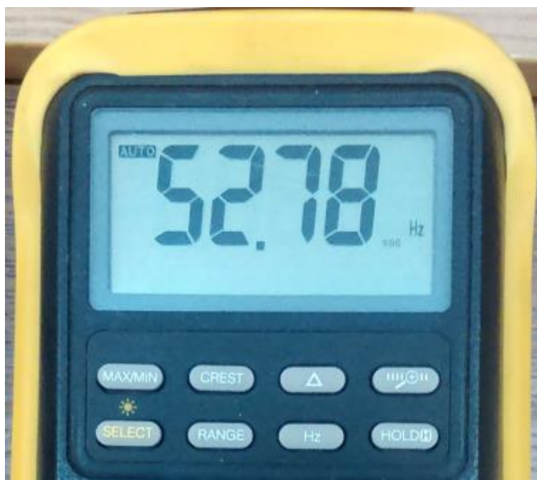
Slika 5.3. Izmjerena frekvencija na sekundarnim stezaljkama transformatora.
