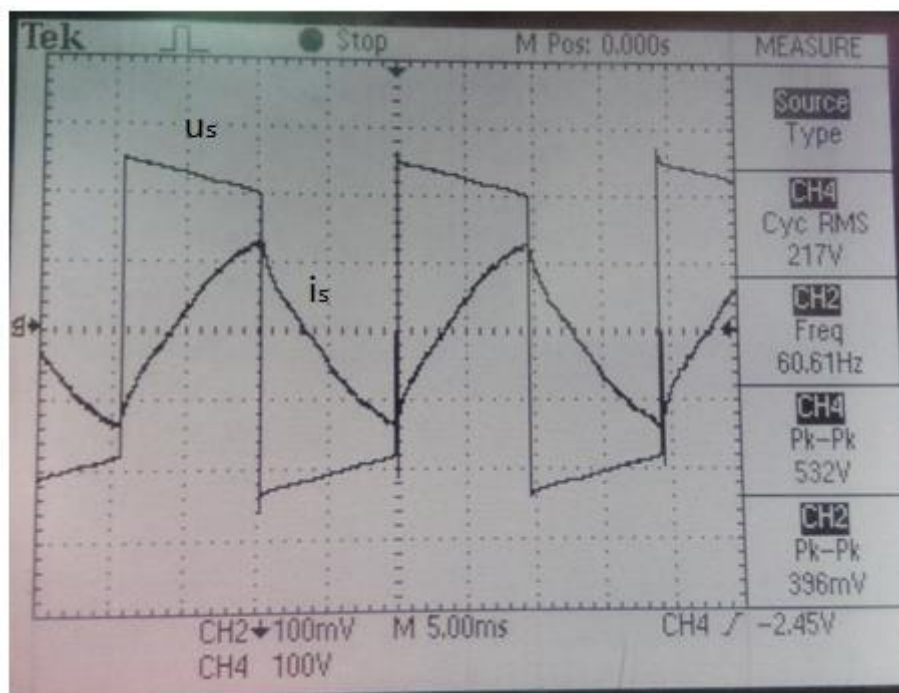
Slika 5.13. Valni oblik napona u_s i struje i_s .
