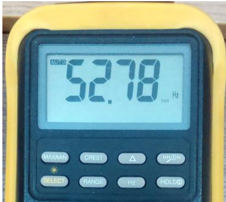
Slika 5.3. Izmjerena frekvencija na sekundarnim stezaljkama transformatora.
