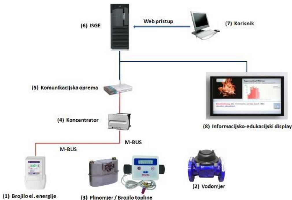
**Slika 3.14.** Shematski prikaz izvedbe sustava daljinskog očitavanja potrošnje energije
