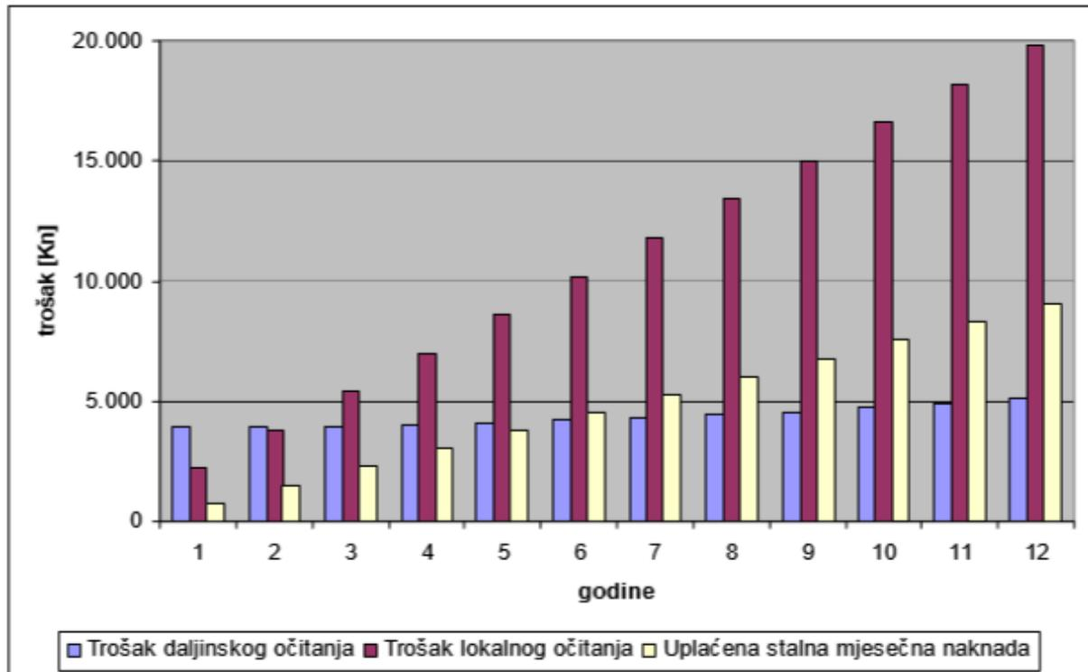
Slika 3.10. Procjena troškova daljinskog i lokalnog očitavanja i uplaćene stalne mjesečne naknade za RTV odašiljač udaljen 25 kilometara od središta za očitavanje i obračun
