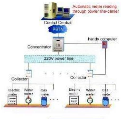
**Slika 3.1.** Koncept daljinskog očitavanja korištenjem PLC tehnologije
