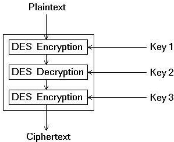
Sl. 2.2: Princip rada 3DES sustava
