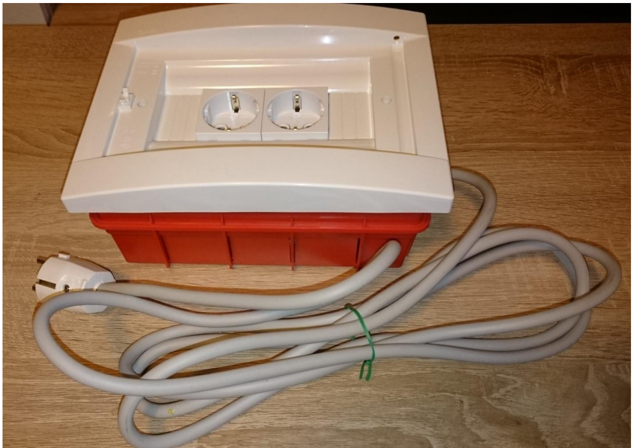
Sl.3.1. – Sklop za mjerenje i kontrolu trošila
