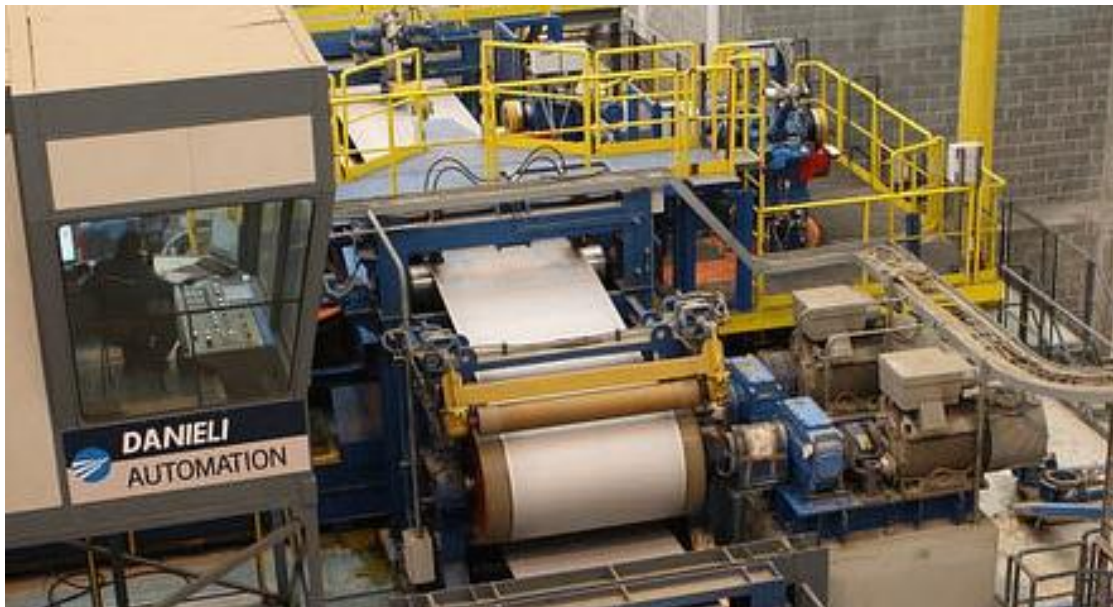
Slika 1.2. Postavljanje materijala pod valjak kojim se upravlja pomoću cilindra
