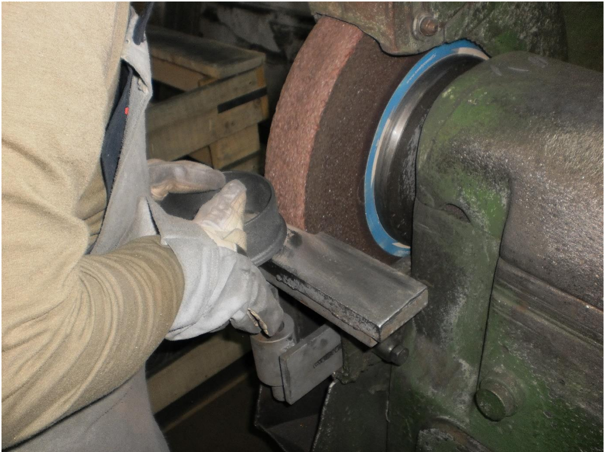
Slika 7.1. Brušenje odljevka ( fotografirano 5.2.2016 )
