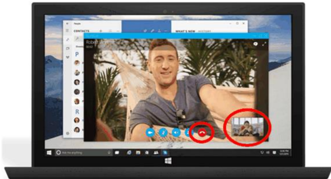
Slika 3.2. Primjer prilagodbe korisničkog sučelja na različitim razlučivostima zaslona [6] Kada se aplikacija pokreće na telefonu, zbog manjeg zaslona za rad, aplikacija može eliminirati pogled slika-u-slici i napraviti gumb za poziv veći kako bi se olakšao rad jednom rukom.
