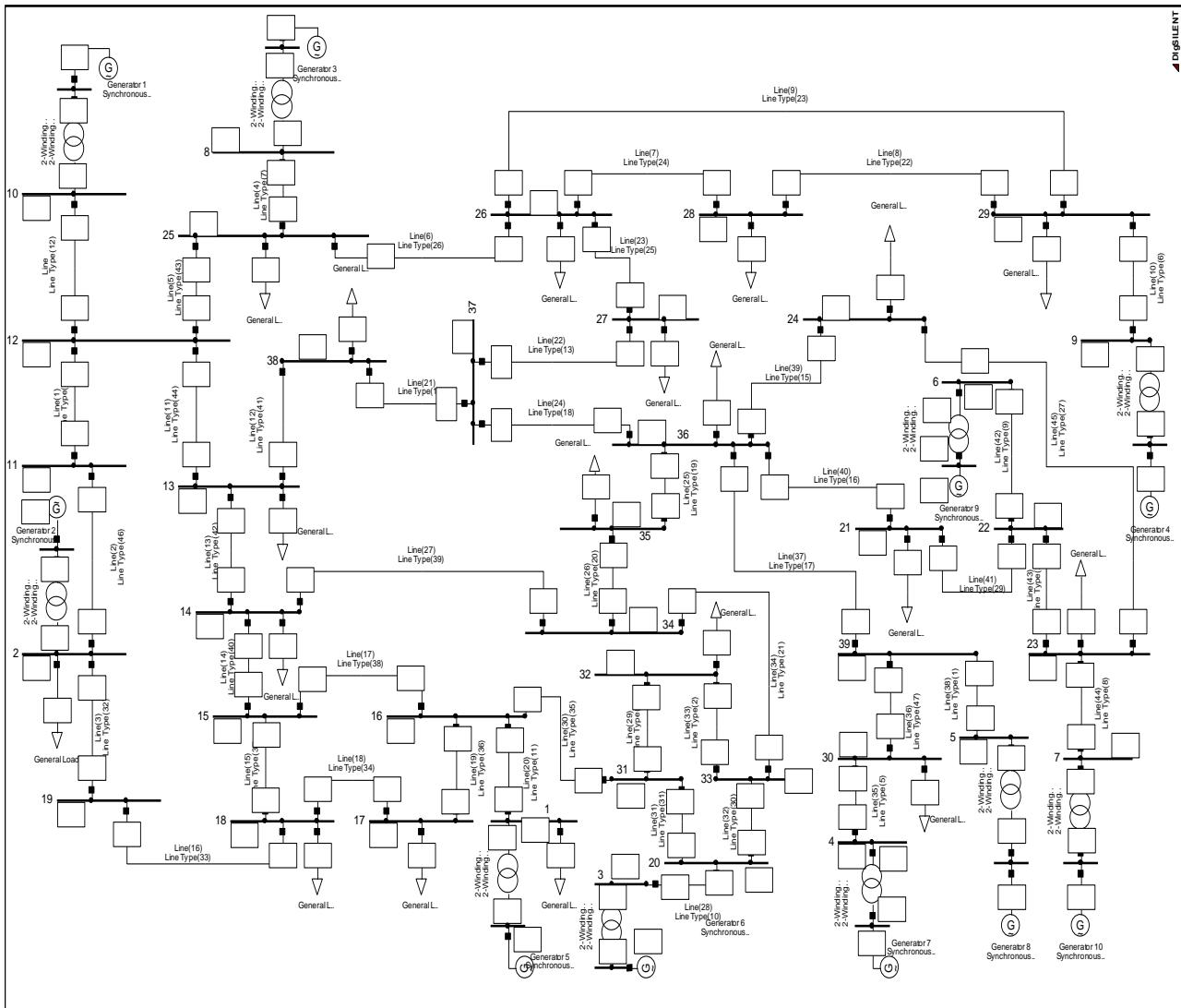
Slika 2.1. Jednopolna shema 39-sabirničkog ispitnog sustava u DIGILENT PowerFactory softveru
