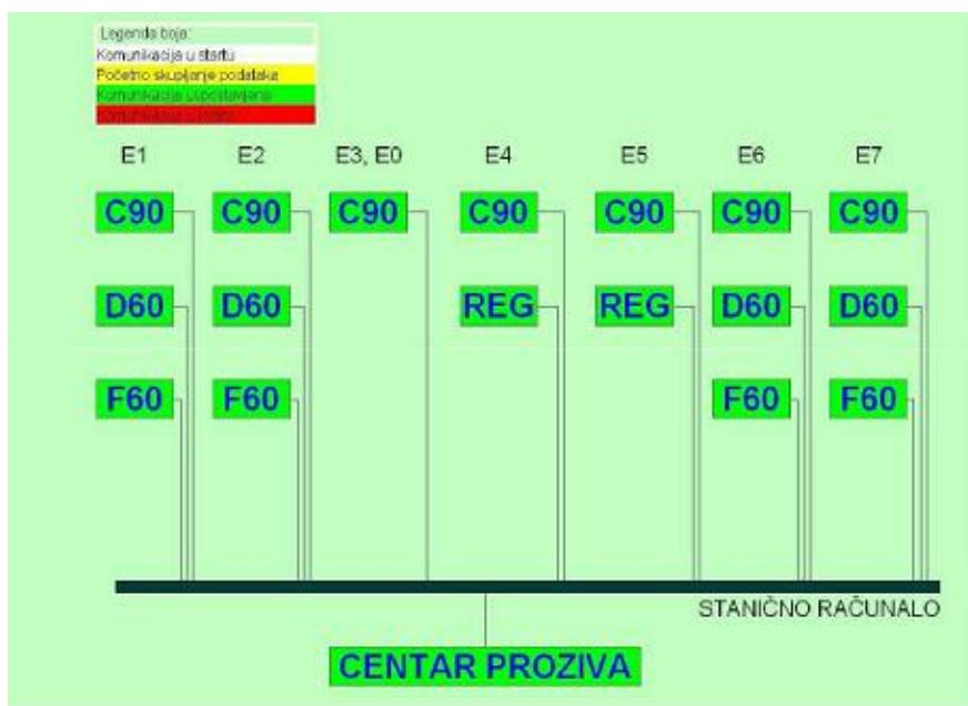
Slika 4.4. Primjer prikaza manipuliranja alarmima na SCADA-i, [17].
