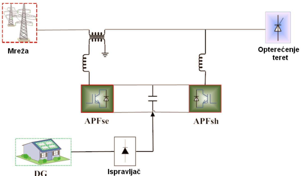
Slika 3.12. UPQC sa DG spojen na DC link, [12].
