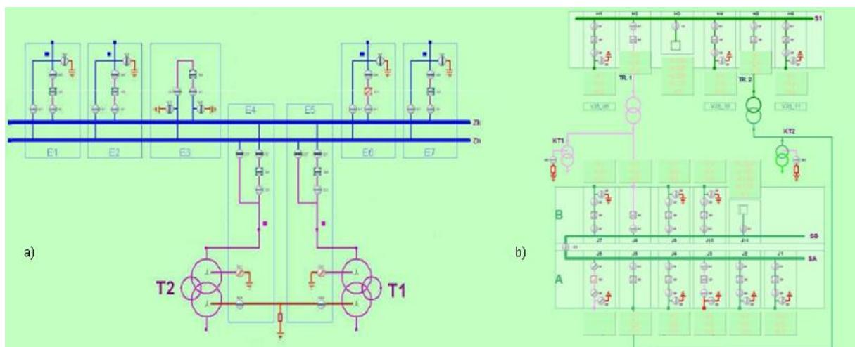
Slika 4.3. Primjer prikaza sheme srednjenačunske trafostanice 35 kV na SCADA-i, [17].
