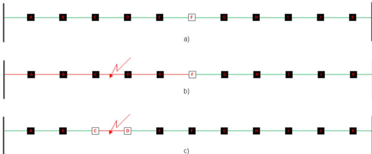
Slika 2.8. a) primjer djelovanja algoritma ARM<sup>1</sup>, b) pojava kvara između čvorova C i D, c) Izolacija i restauracija napajanja, [6].
