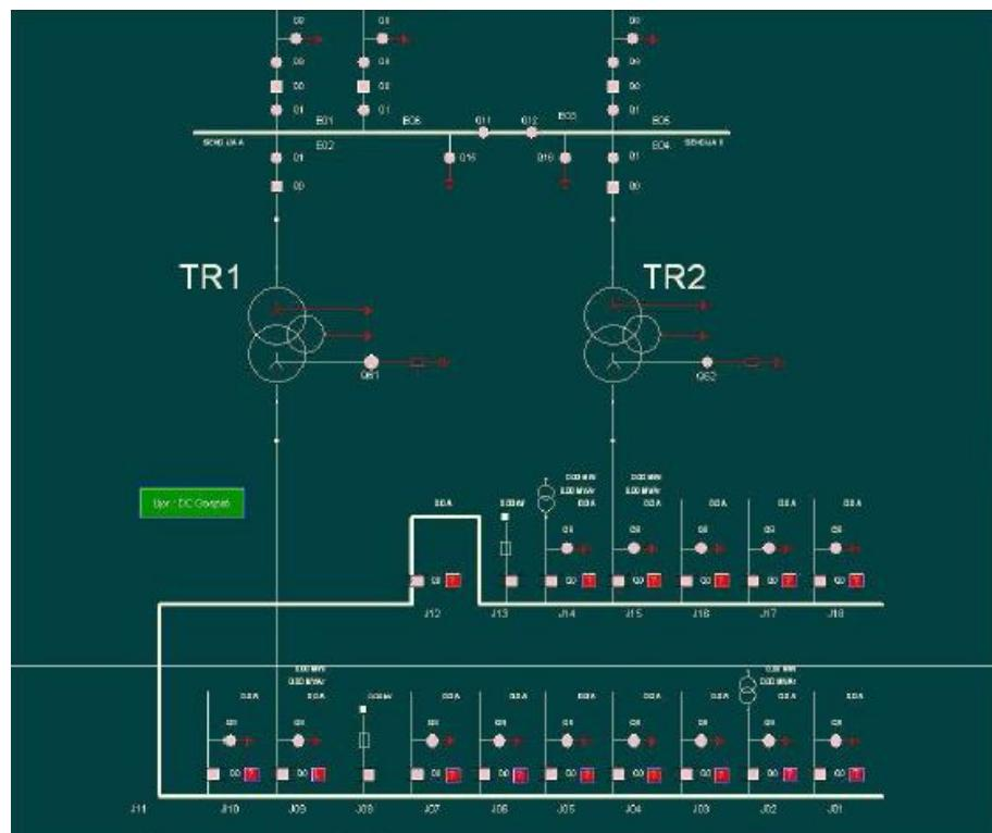
Slika 4.1. Shema srednjenačne trafostanice 20 kV na SCADA-i, [17].
