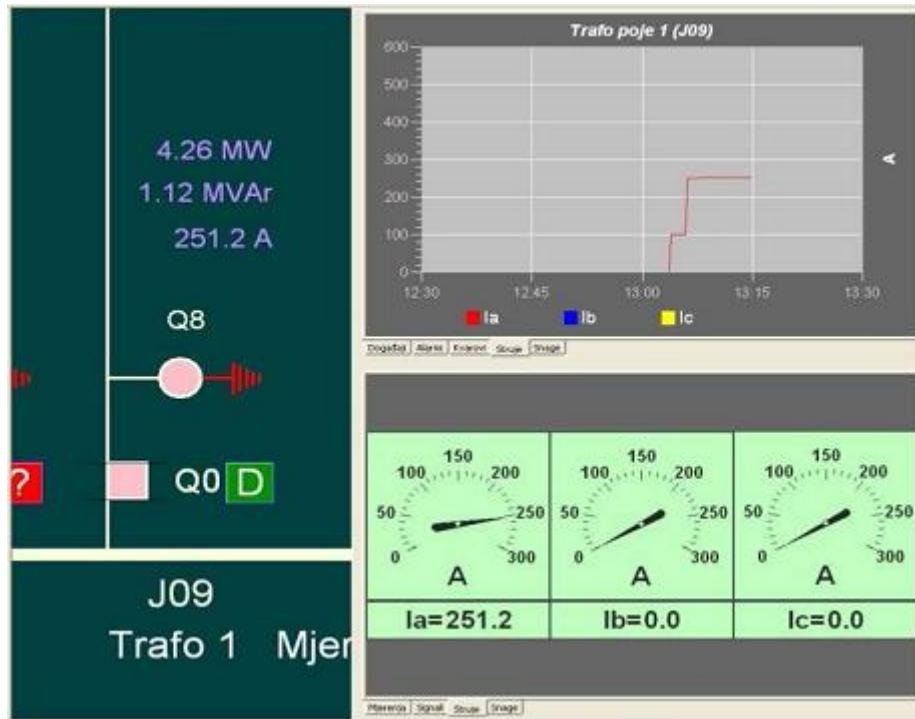
Slika 4.2. Primjer prikaza mjerjenja i trend dijagrama na SCADA-i, [17].
