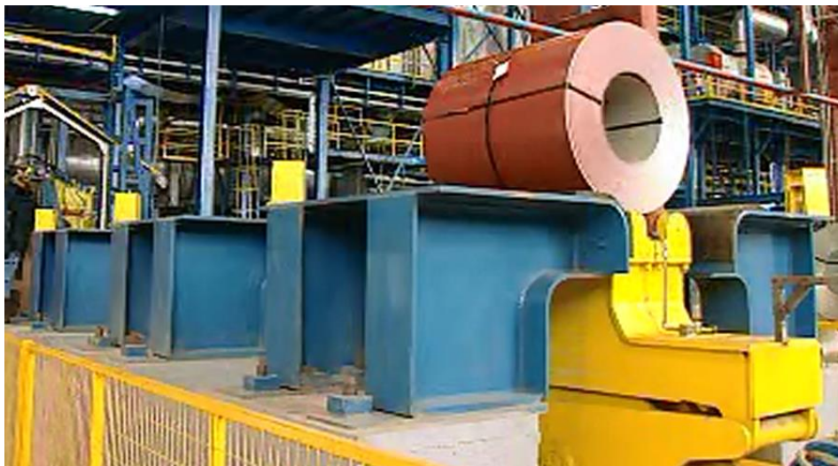
Slika 3.2. Namotaj se pozicionira na određenu poziciju
