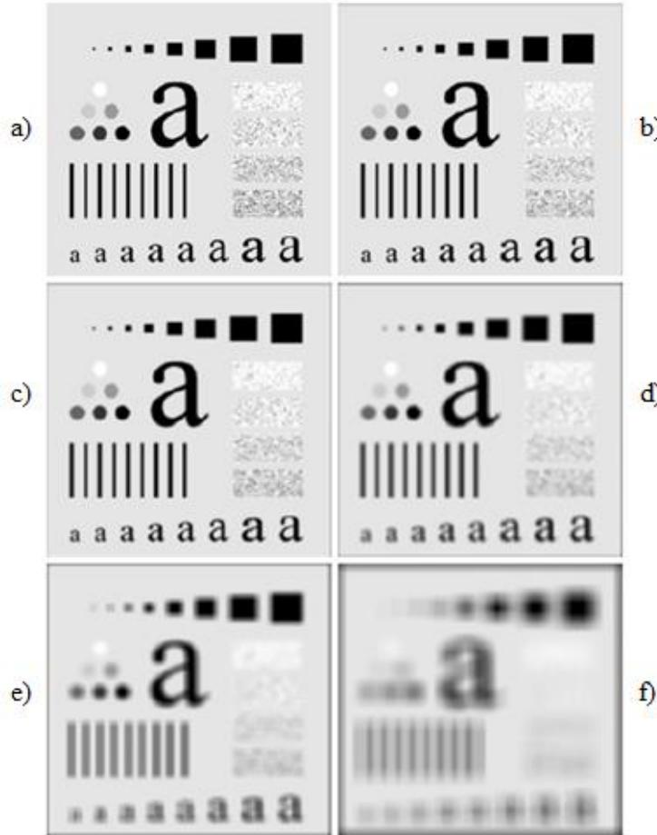
**Slika 4.3** (a) originalna slika, (b) slika filtrirana *moving average* filtrom reda  $n=3$ , (c) slika filtrirana *moving average* filtrom reda  $n=5$ , (d) slika filtrirana *moving average* filtrom reda  $n=9$ , (e) slika filtrirana *moving average* filtrom reda  $n=15$ , (f) slika filtrirana *moving average* filtrom reda  $n=35$  [2]
