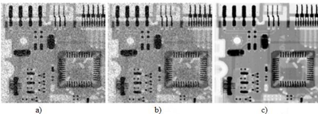
**Slika 4.6** a) Rentgenska slika pločice sa „sol i papar“ šumom, b) slika filtrirana  $3 \times 3$  average filtrom, c) slika filtrirana medijan filtrom [2]
