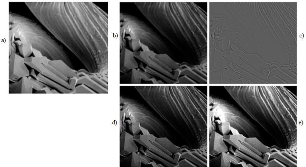
**Slika 4.13.** Primjena *High boost* filtra pomoću Laplacianovog filtra, (a) slika skeniranja elektronskim mikroskopom, (b) tamnija verzija slike (a), (c) slika filtrirana Laplacianovim filterom uz  $A=0$ , (d) slika filtrirana Laplacianovim filterom uz  $A=1$ , (e) slika filtrirana Laplacianovim filterom uz  $A=1.7$
