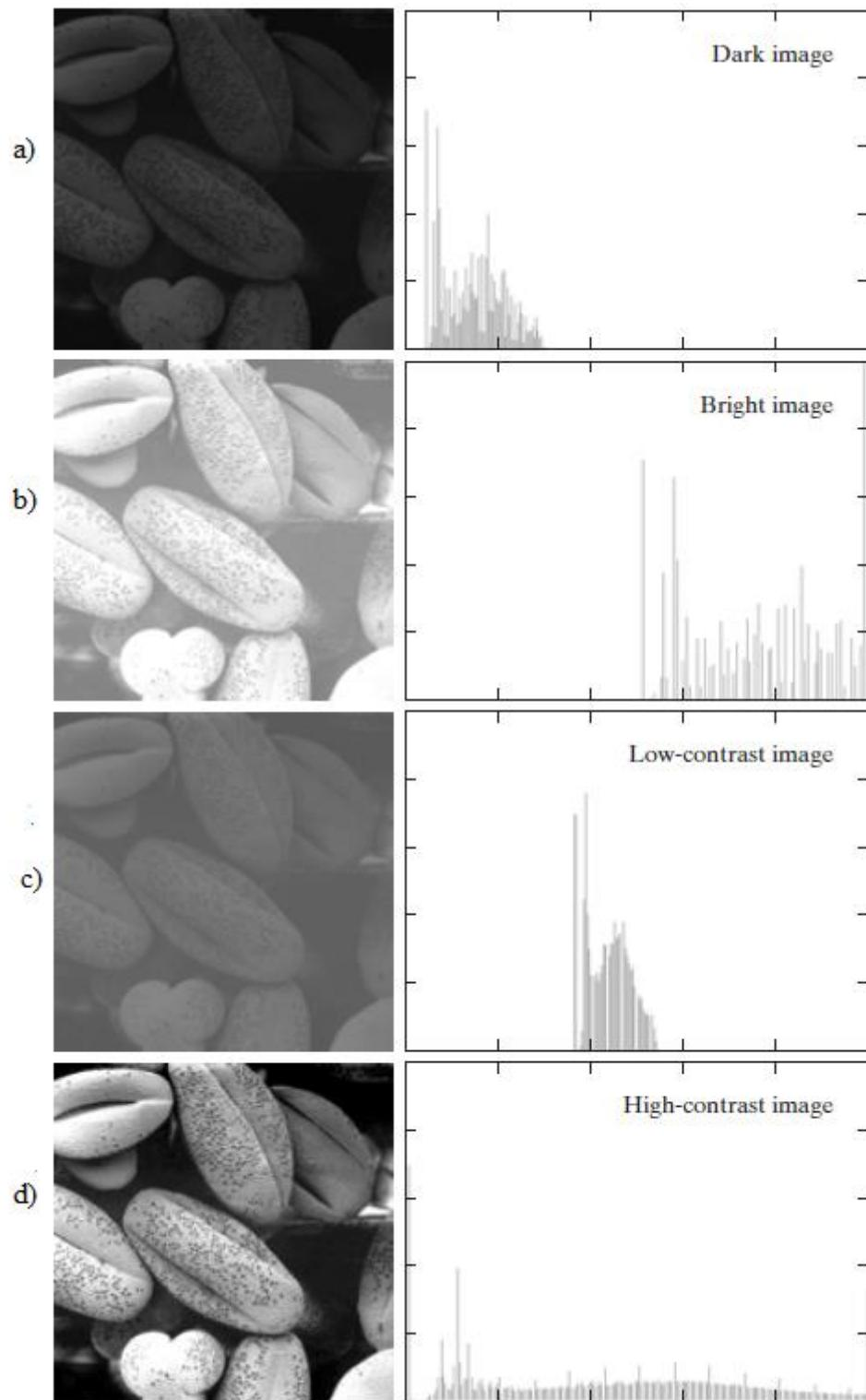
**Slika 3.4** Slika peludi (a) tamna slika, (b) svjetla slika, (c) slika s malim kontrastom, (d) slika s velikim kontrastom [2]
