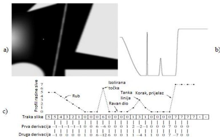
**Slika 4.8** (a) Jednostavna slika, (b) 1D horizontalni profil slike, c) pojednostavljeni profil slike s 1. i 2. derivacijom [2]
