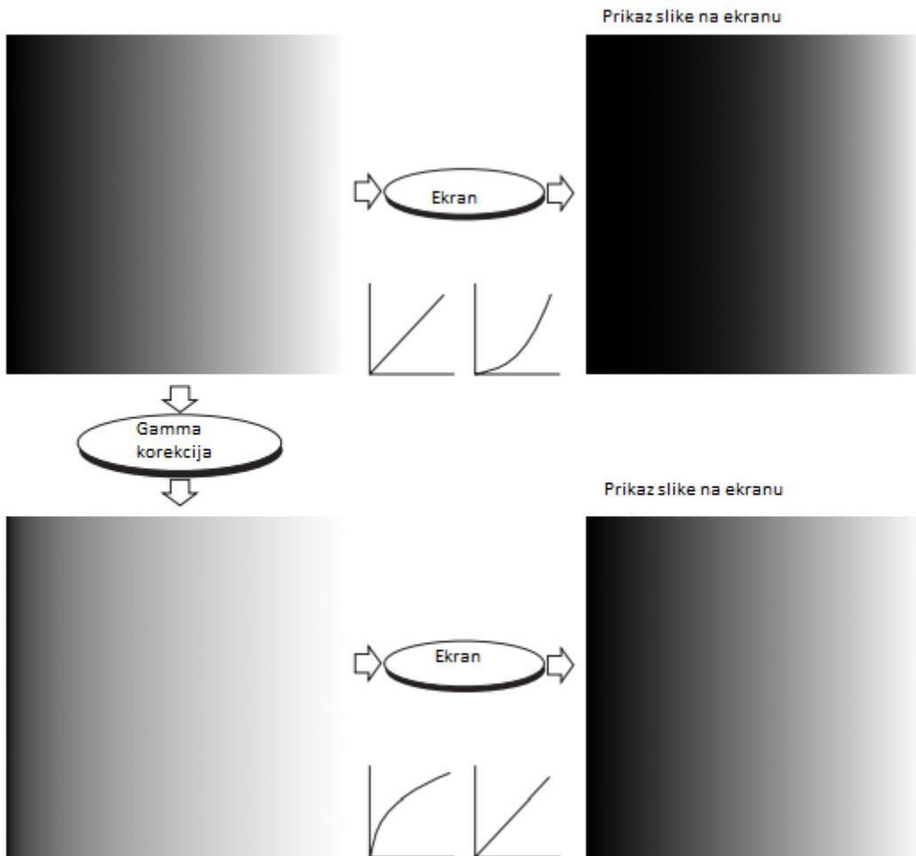
**Slika 3.3** Uskopojasna linearna slika prikazana na ekranu te njezina korekcija gama transformacijom [2]
