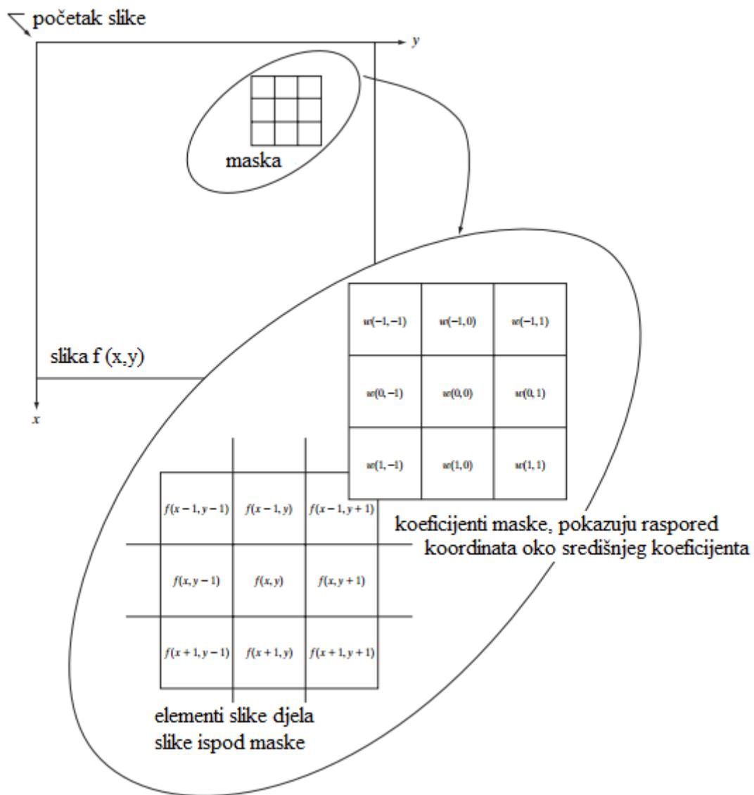
Slika 4.1 Princip rada 2D prostornog filtriranja [2]
