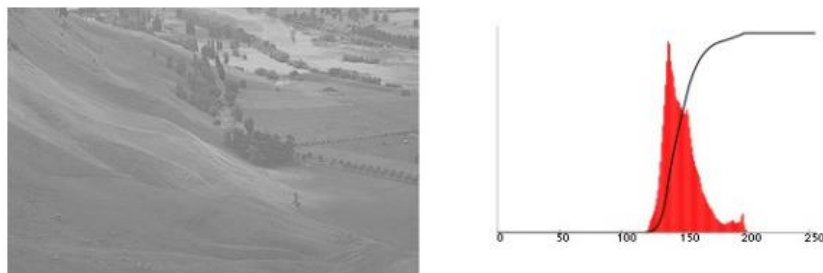
Slika 3.5 Slika s neujednačenim histogramom i njezin histogram [3]
