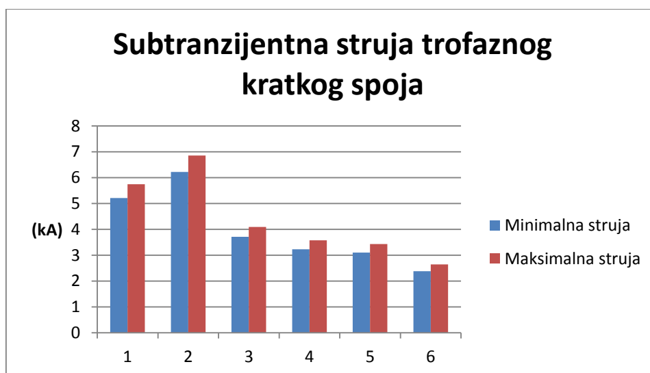
Slika 4.11: Vrijednosti maksimalne subtranzijentne struje trofaznog kratkog spoja I''_k
