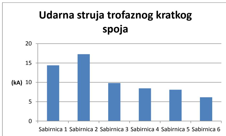
**Slika 4.19:** Vrijednost maksimalne udarne struje trofaznog kratkog spoja  $i_p$
