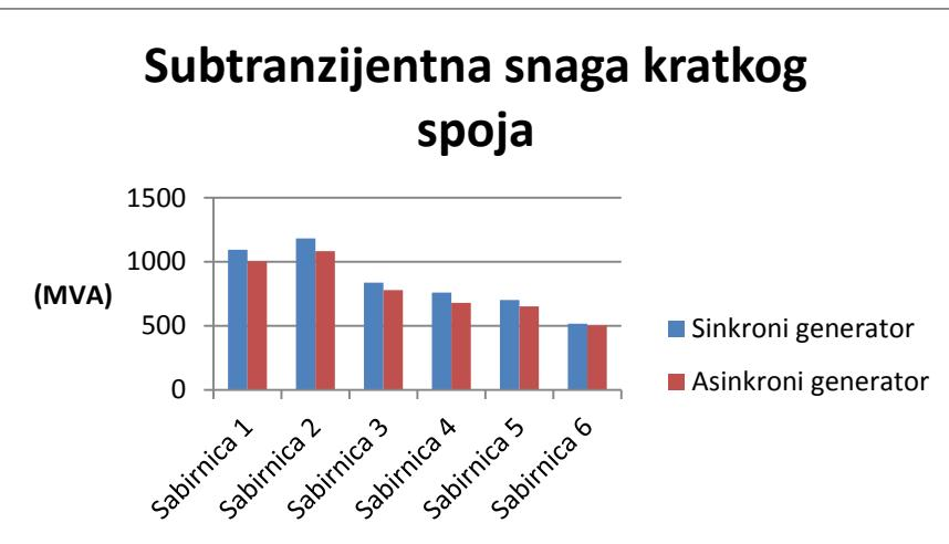
**Slika 4.21:** Usporedba subtranzijentne snage sinkronog i asinkronog generatora
