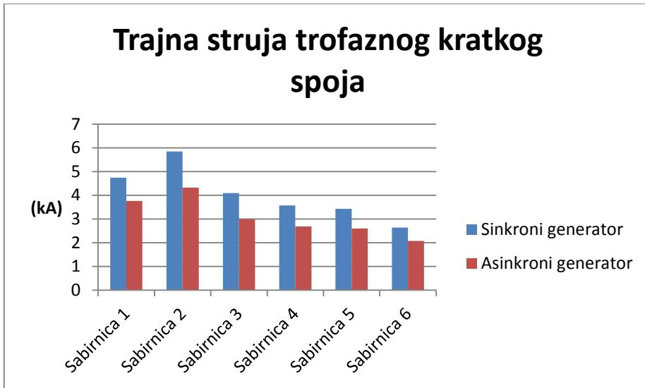
**Slika 4.24:** Usporedba trajne struje trofaznog kratkog spoja sinkronog i asinkronog generatora
