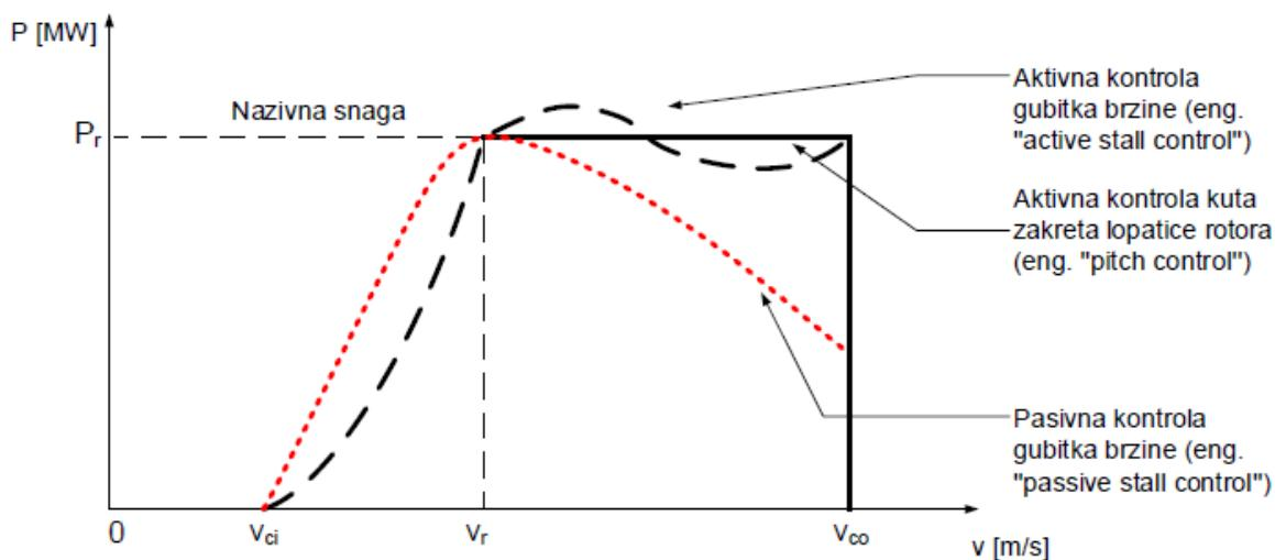
**Slika 3.2:** Krivulja snage vjetroelektrane u ovisnosti o regulaciji snage
