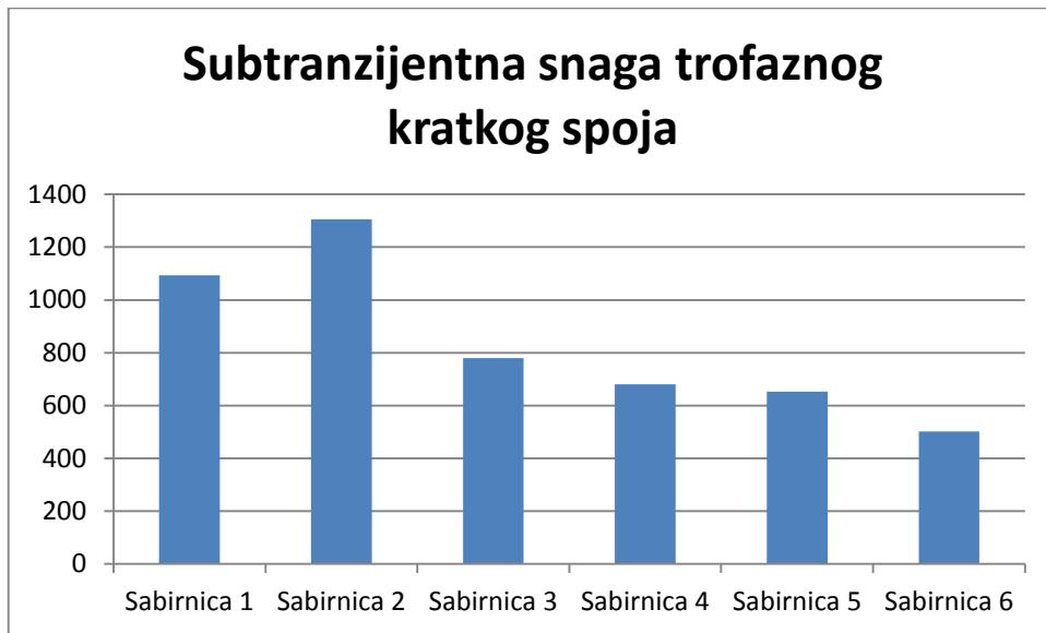
**Slika 4.18:** Vrijednosti maksimalne subtranzijentne snage kratkog spoja  $S''_k$
