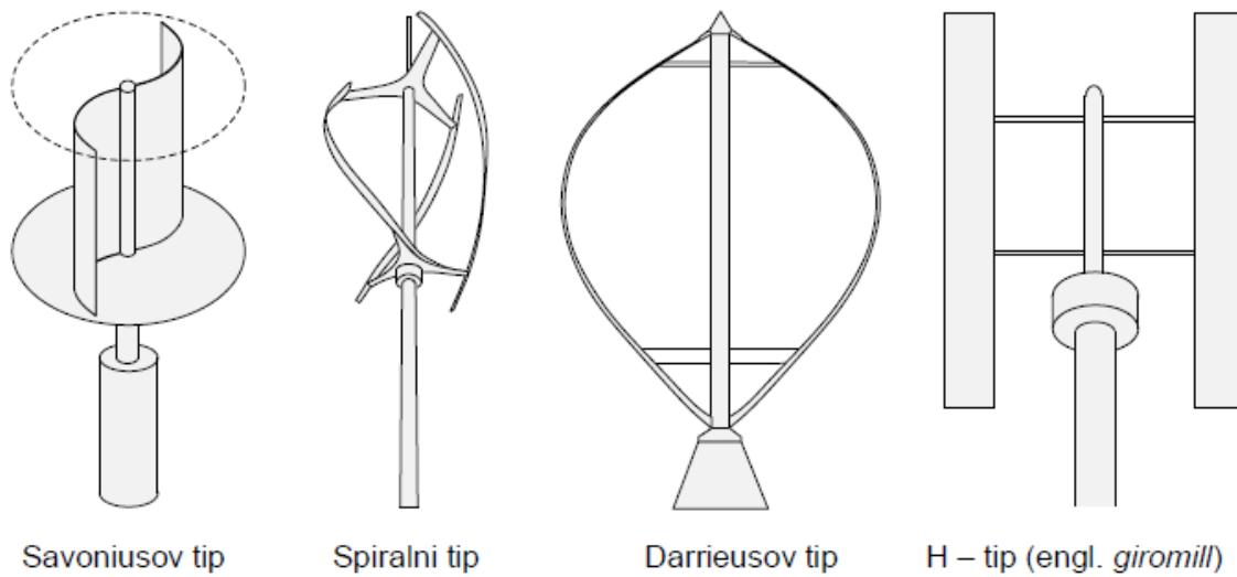
**Slika 2.9:** Tipovi rotora vjetroelektrana s vertikalnom osi vrtnje
