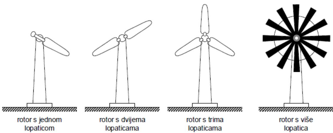
**Slika 2.6:** Tipovi rotora vjetroelektrana s horizontalnom osi vrtnje (rotor s jednom, dvjema, trima i više lopatica)
