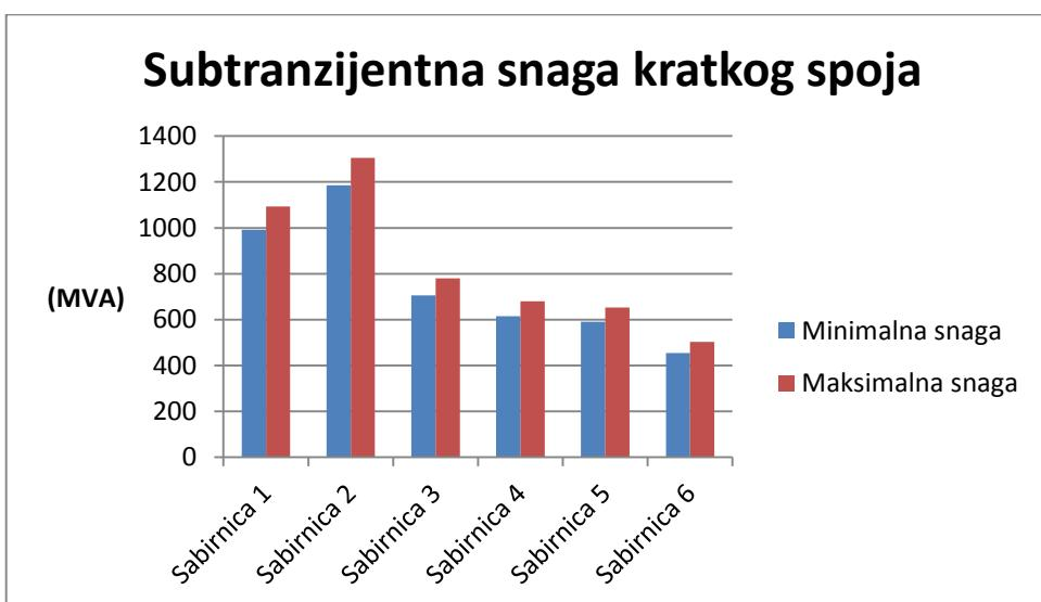
**Slika 4.4:** Minimalna i maksimalna vrijednost subtranzijentne snage trofaznog kratkog spoja  $S''_k$
