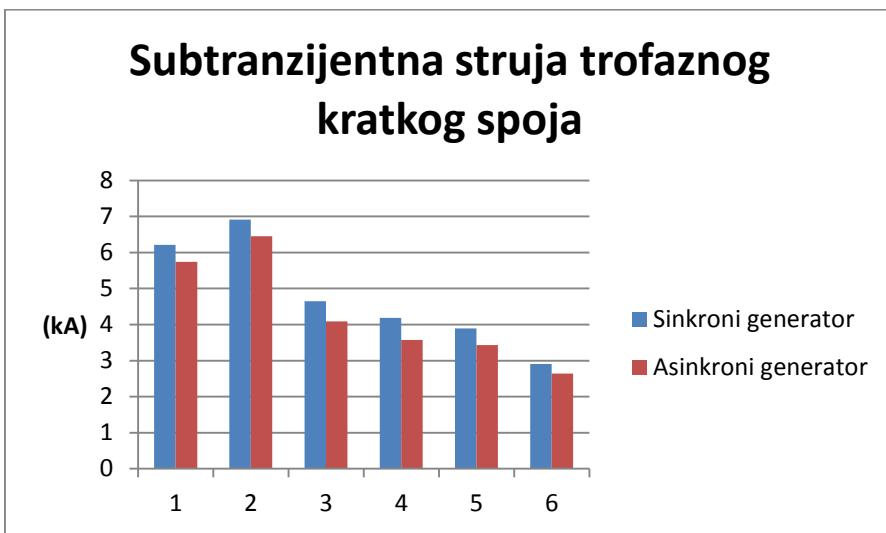
**Slika 4.22:** Usporedba subtranzijentne struje sinkronog i asinkronog generatora
