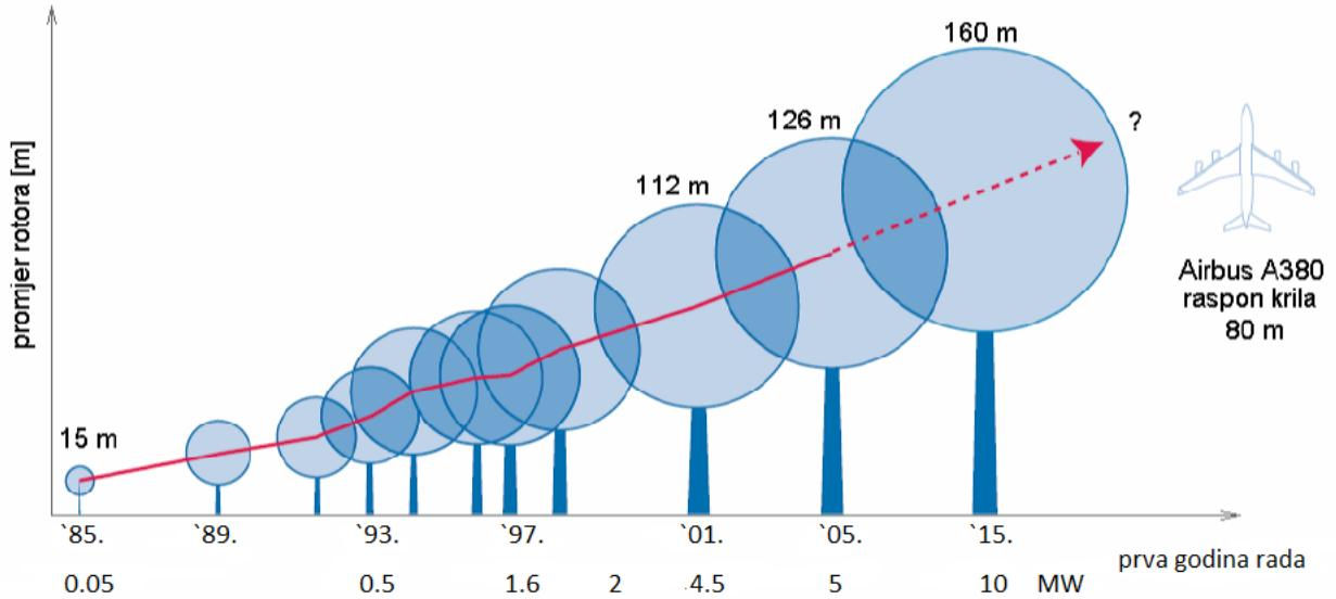
**Slika 2.10.** Povećanje promjera rotora u proteklih trideset godina[11]
