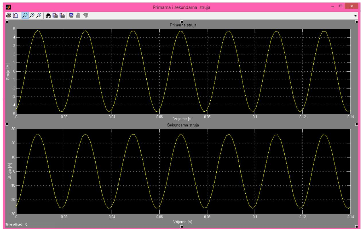
Slika 4.2. Primarna i sekundarna struja za RL trošilo
