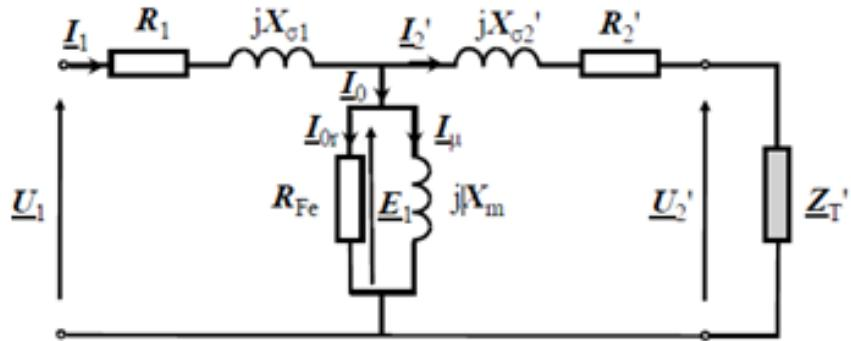
Slika 2.9. Nadomjesna shema transformatora pod opterećenjem [2]
