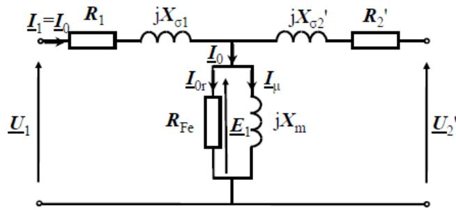
Slika 2.7. Nadomjesna shema praznog hoda transformatora. [2]
