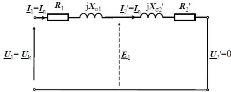
Slika 2.8. Nadomjesna shema transformatora za pokus kratkog spoja [2]
