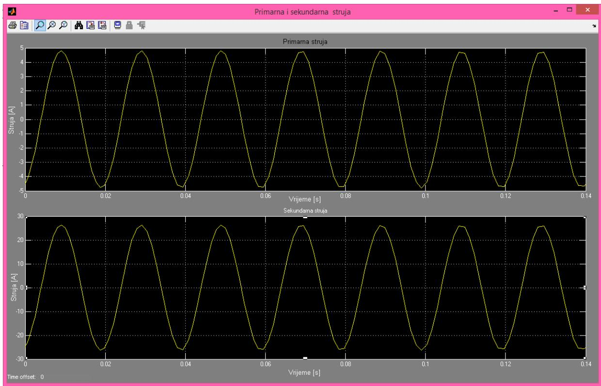
Slika 4.6. Primarna i sekundarna struja za R trošilo
