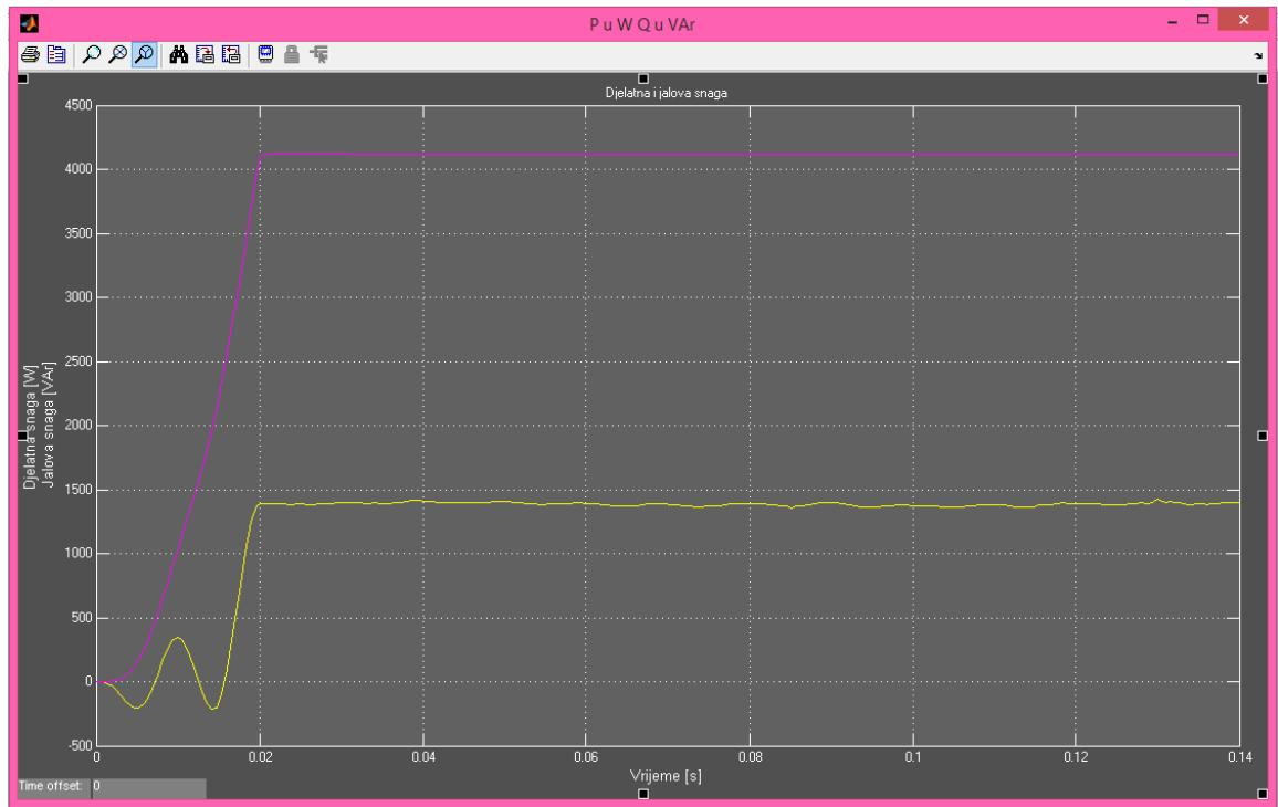
Slika 4.9. Ulazne snage jednofaznog transformatora
