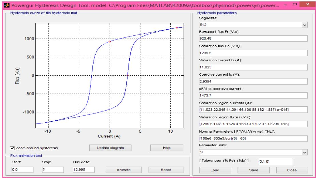
Slika 4.17. Petlja histereza transformatora korištenog u modelu
