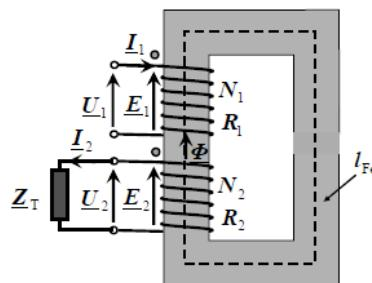
Slika 2.5. Princip rada transformatora s priključenim trošilom [2]
