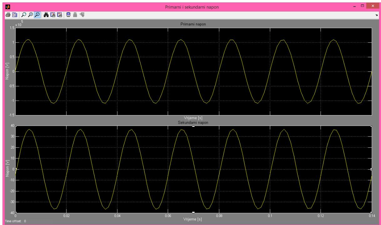
Slika 4.3. Primarni i sekundarni napon za RL trošilo
