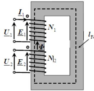
Slika 2.4. Princip rada transformatora bez priključenog trošila [2]
