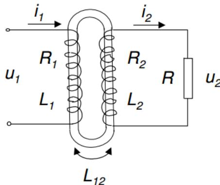
Slika 2.6. Shematski prikaz općih jednadžbi transformatora [2]
