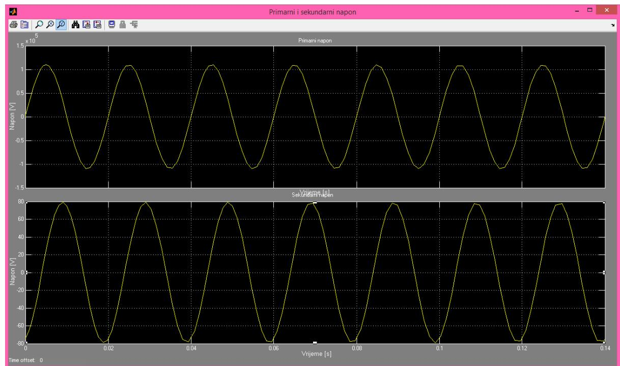
Slika 4.5. Primarni i sekundarni napon za RC trošilo
