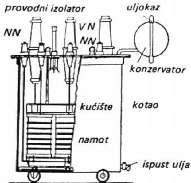
Slika 2.3. Vanjski djelovi transformatora [5]
