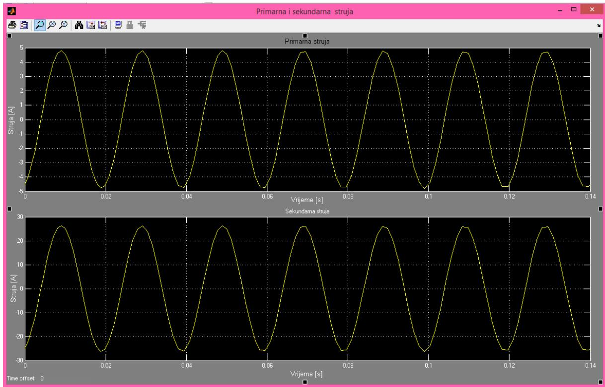
Slika 4.4. Primarna i sekundarna struja za RC trošilo
