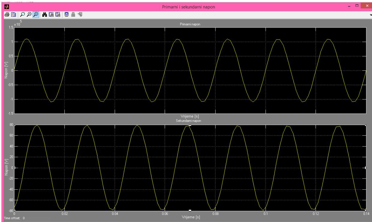
Slika 4.7. Primarni i sekundarni napon za R trošilo
