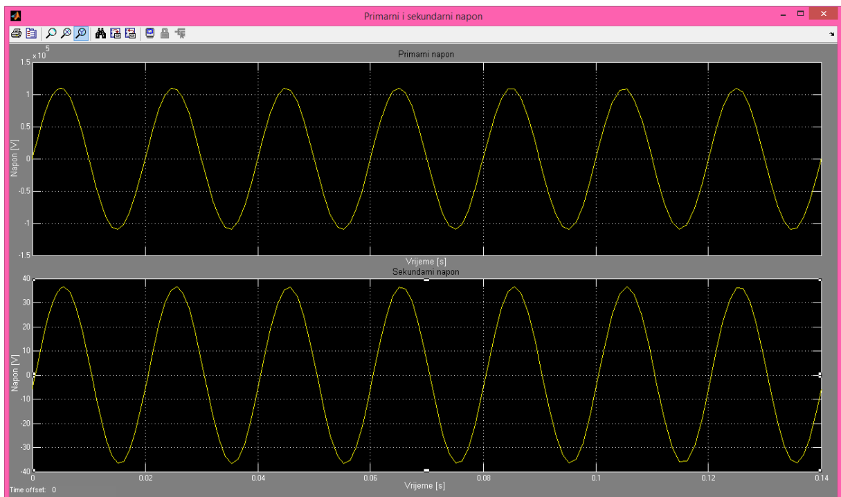
Slika 4.3. Primarni i sekundarni napon za RL trošilo
