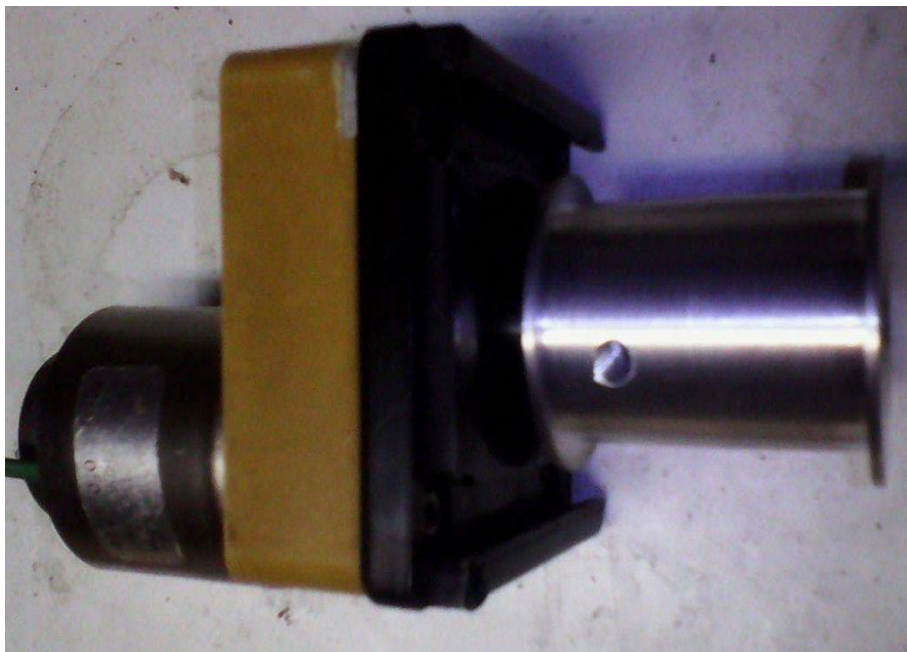
Sl. 3.2. Istosmjerni motor s aluminijskim valjkom.
