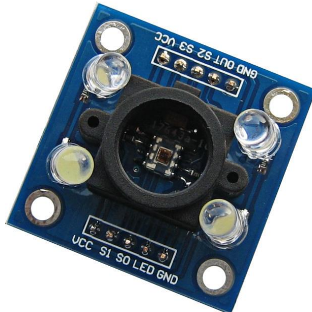
Sl. 3.8. TCS3200 mjerni član za prepoznavanje boje [10].
