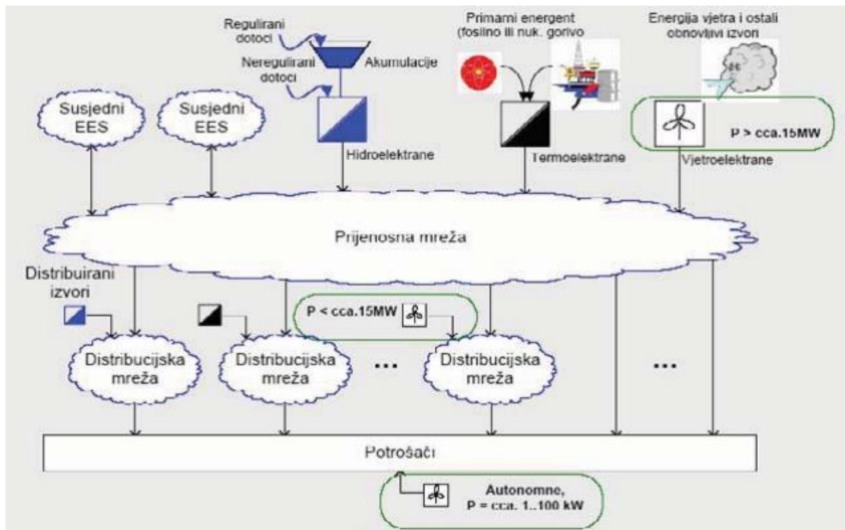
*Slika 2.2. Priključenje distributivnih elektrana u elektroenergetskom sustavu [6,str. 64]*
