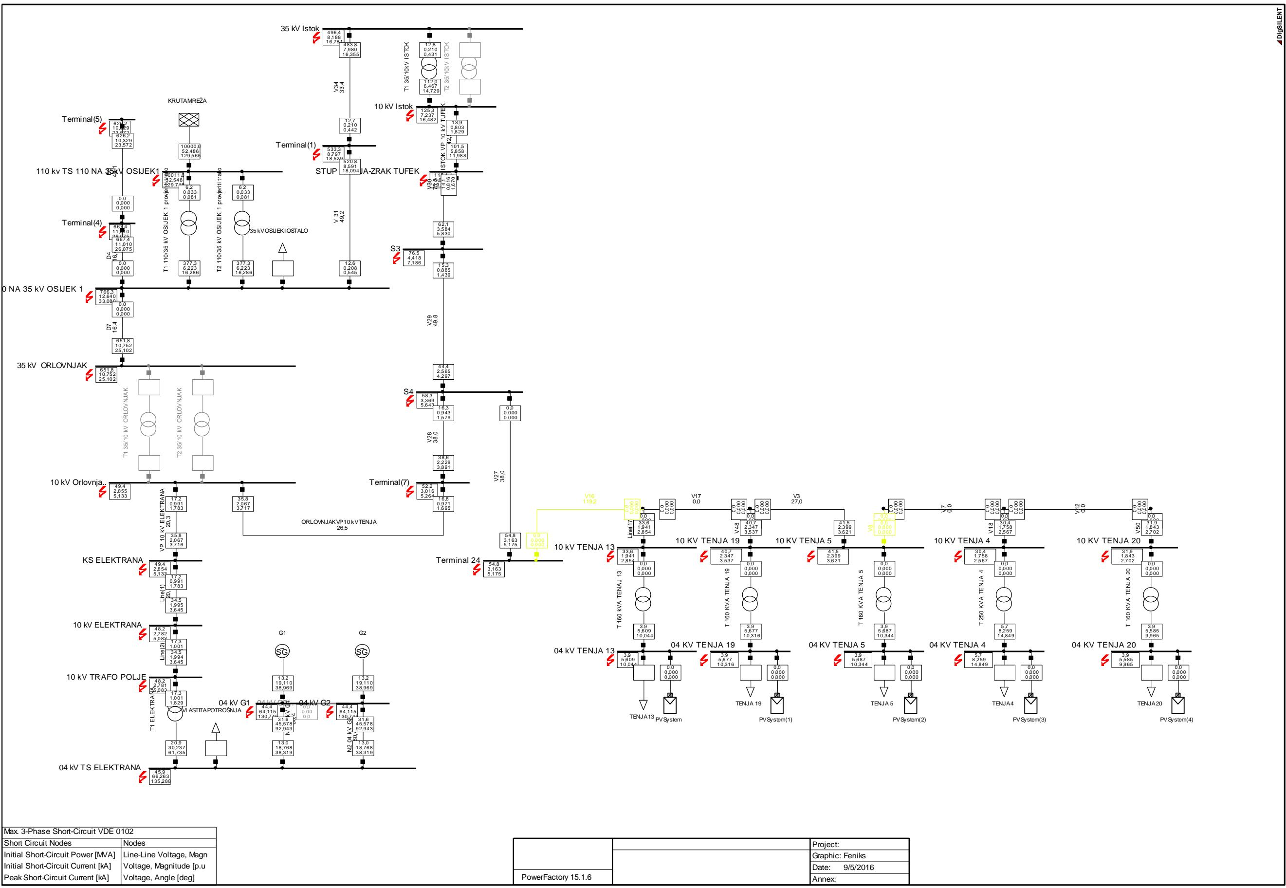
*Slika 5.14. Trofazni kratki spojevi na svim sabirnicama osnovnog modela uz fotonaponske sustave na sabirnicama*
