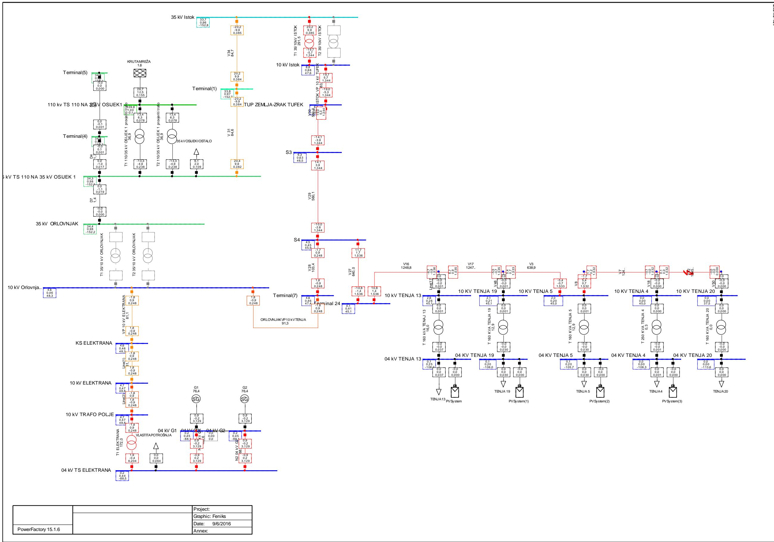
**Prilog P.5.4 Trofazni kratki spoj na sredini voda unutar pasivnog poprečnog (lateralnog) distributivnog izvoda s priključenjem izvoda sa dva generatora**
