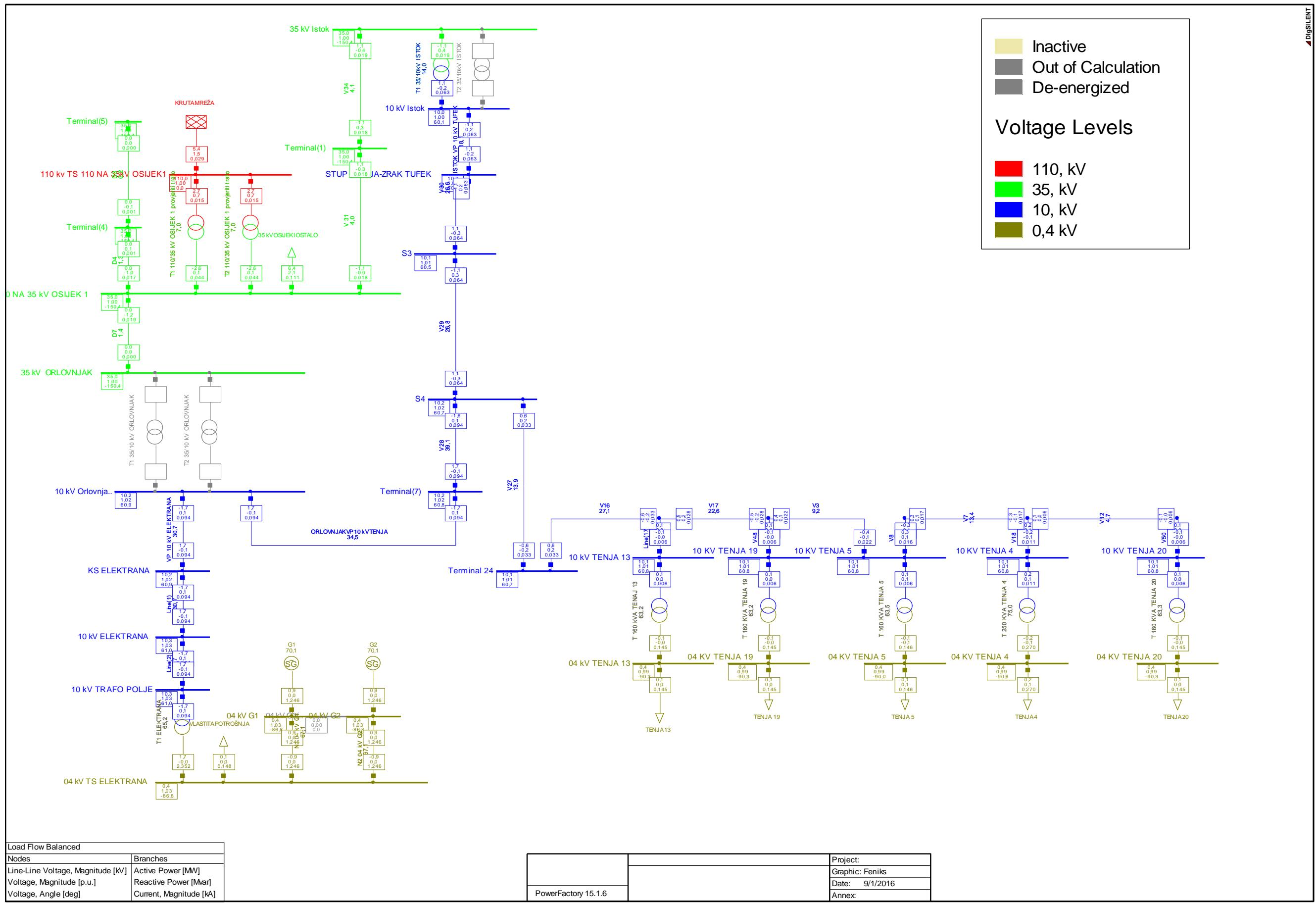
Slika 5.1. Model reduciranih djela elektroenergetske mreže s priključenim bioplinskim generatorima [12]
