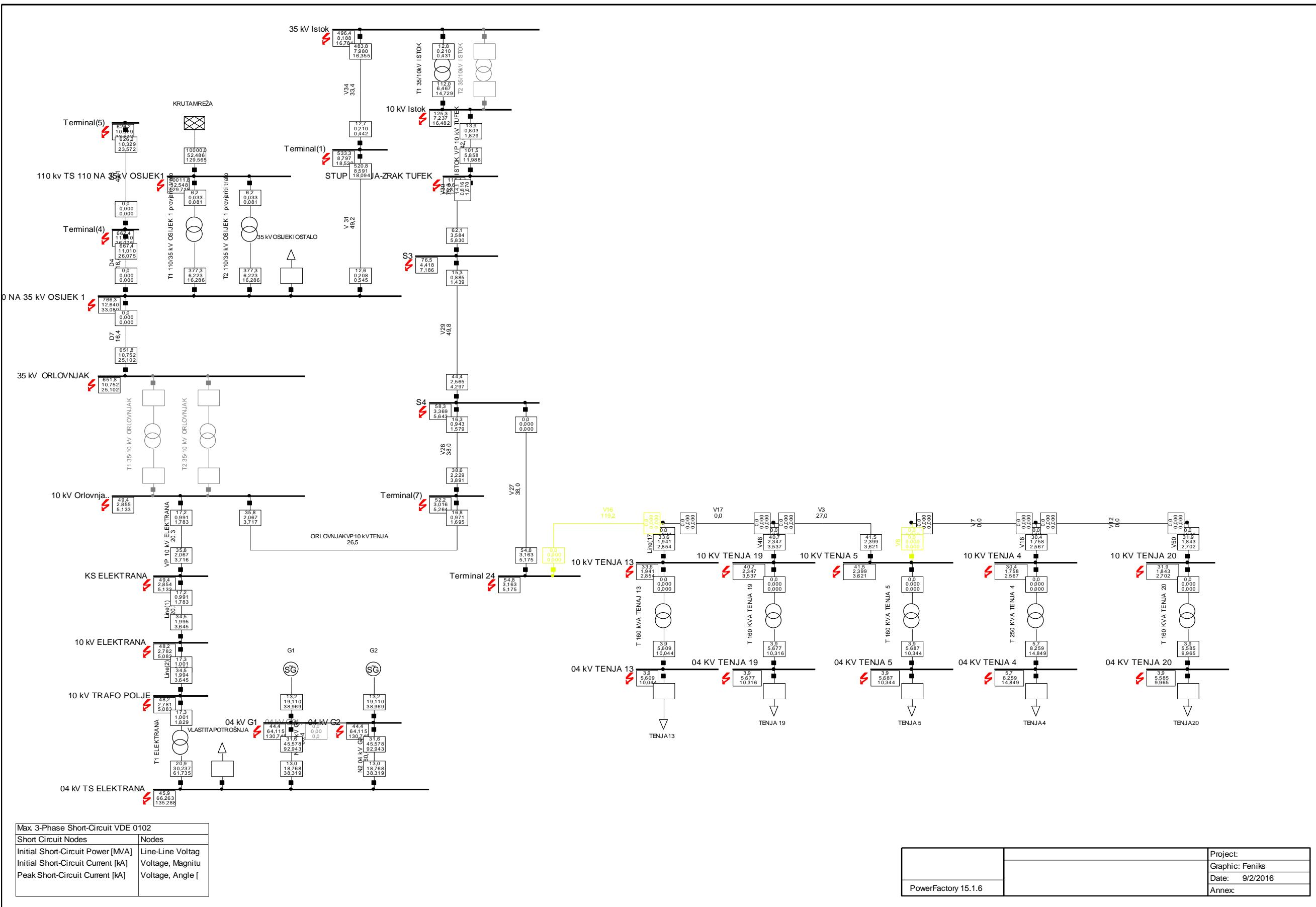
Slika 5.10 Trofazni kratki spojevi na svim sabirnicama-osnovni model mreže
