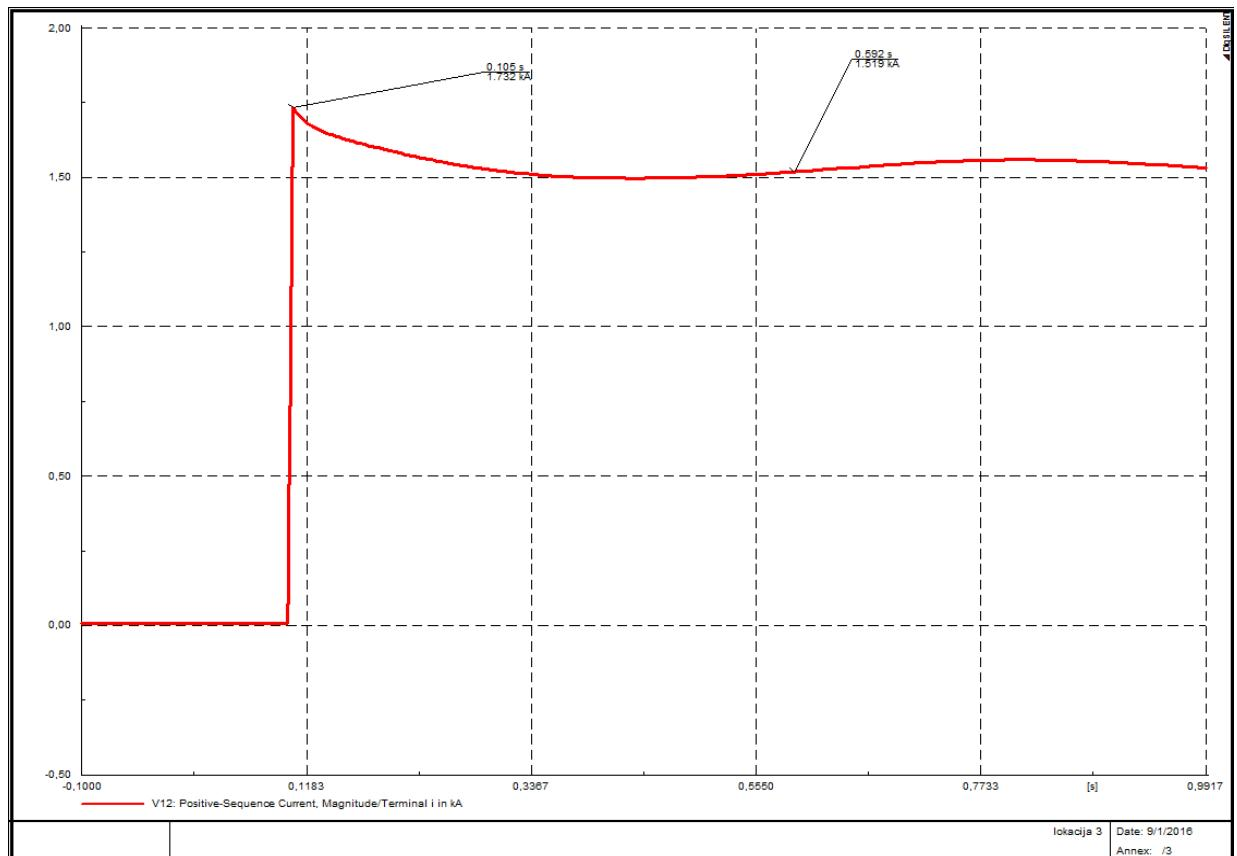
*Slika 5.6. Subtranszijentna struja kratkog spoja u slučaju uključenih generatora*
