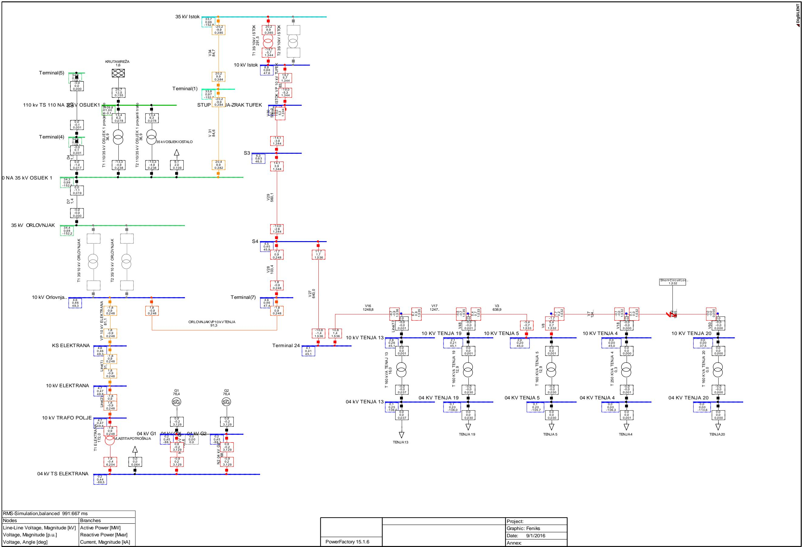
**Prilog P.5.3. Trofazni kratki spoj na sredini voda unutar pasivnog poprečnog (lateralnog) distributivnog izvoda s priključenjem fotonaponskih moduula**
