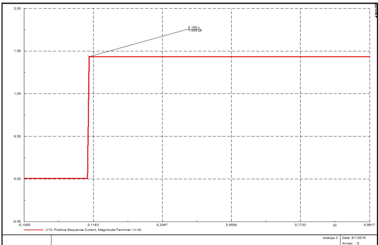
*Slika 5.6. Subtranszijentna struja kratkog spoja u slučaju isključenih generatora*
