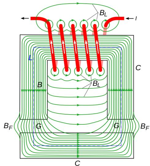
*Slika 3.2. Prikaz elektromagneta [2].*
