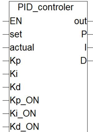
Slika 4.3. Funkcijski blok PID regulatora.
