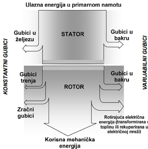
Slika 7.1 Gubici u asinkronom (indukcijskom) električnom motoru [14]
