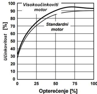
Slika 7.2 Učinkovitost standardnog i visokoučinkovitog motora [14]
