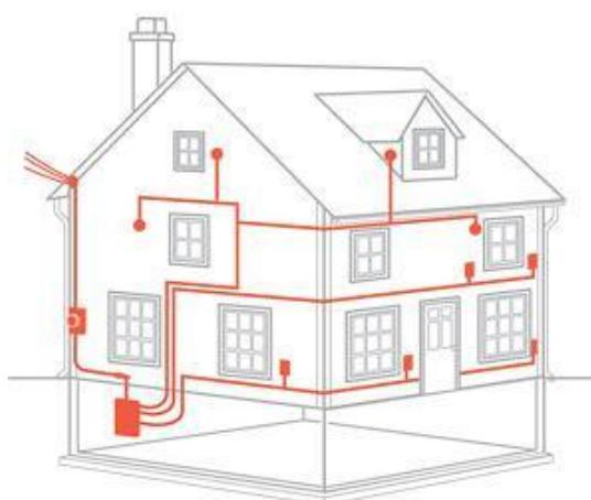
Slika 2.1 Primjer električne instalacije u obiteljskoj kući [5]
