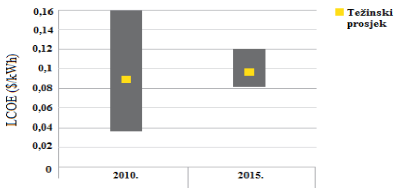
Slika 3.35. Rasponi LCOE-a za TE na ugljen u 2010. i 2015. te težinski prosjek LCOE-a [21]
