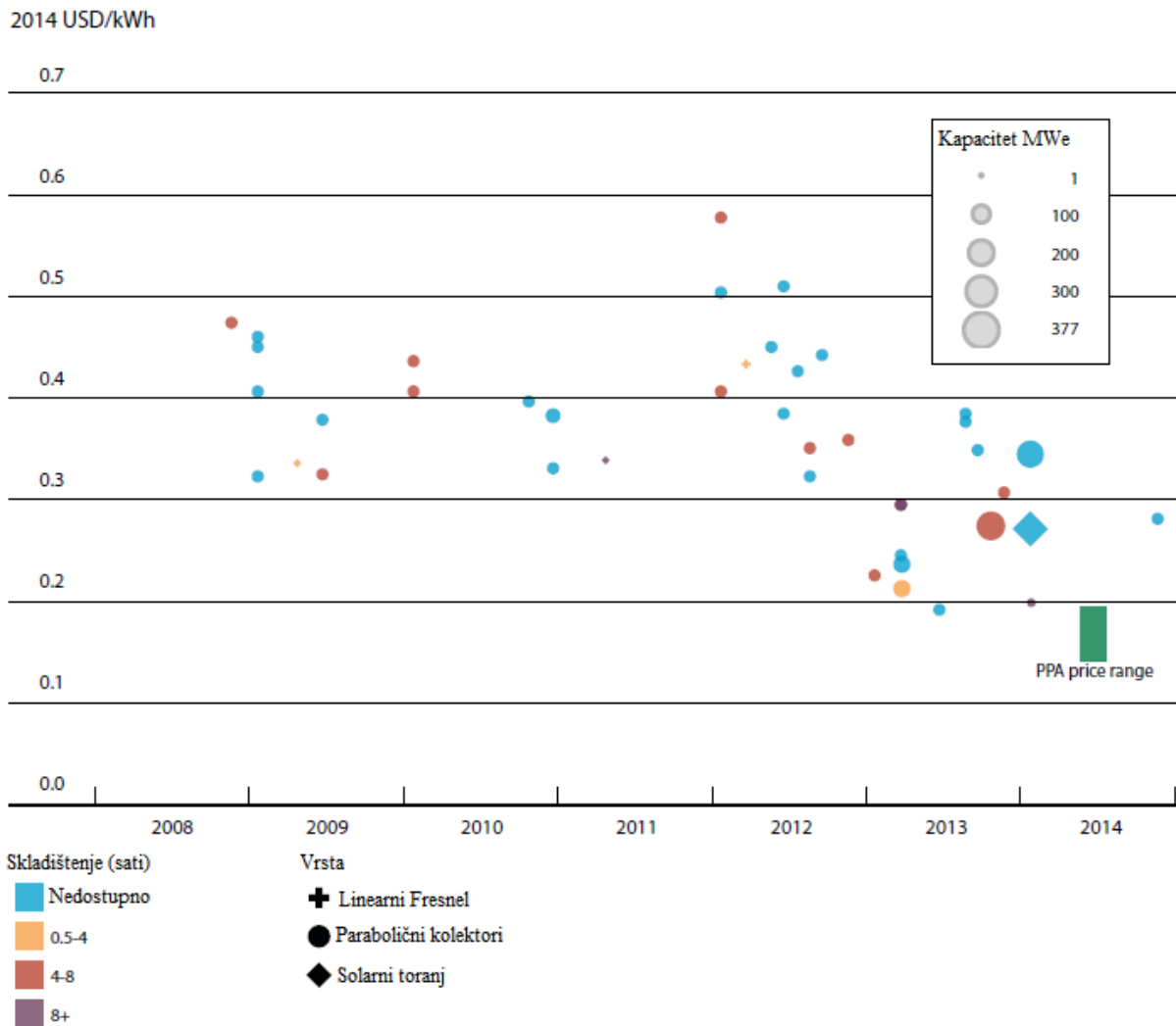
Slika 3.23. LCOE za koncentrične solarne elektrane od 2008. do 2014. godine [12]
