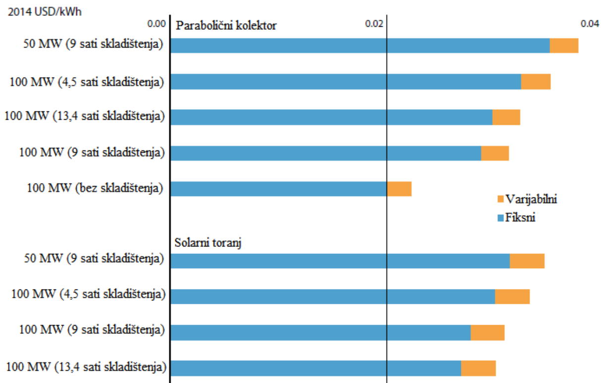
Slika 3.21. Troškovi upravljanja i održavanja za PTC i elektrane sa solarnim tornjem [12]
