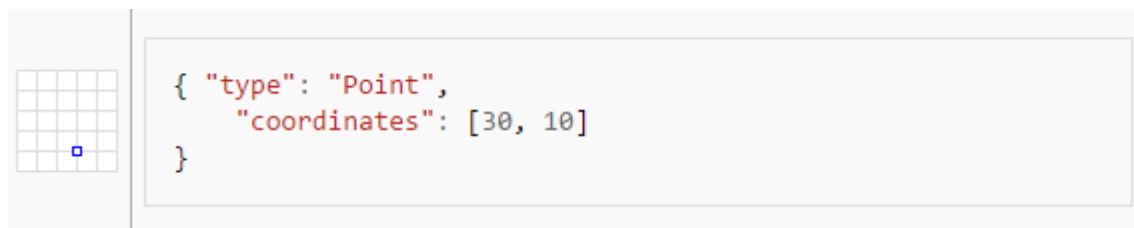
Slika 3.3. Primjer GeoJSON objekta za tip „ Point “ [Izvor: https://en.wikipedia.org/wiki/GeoJSON ]
