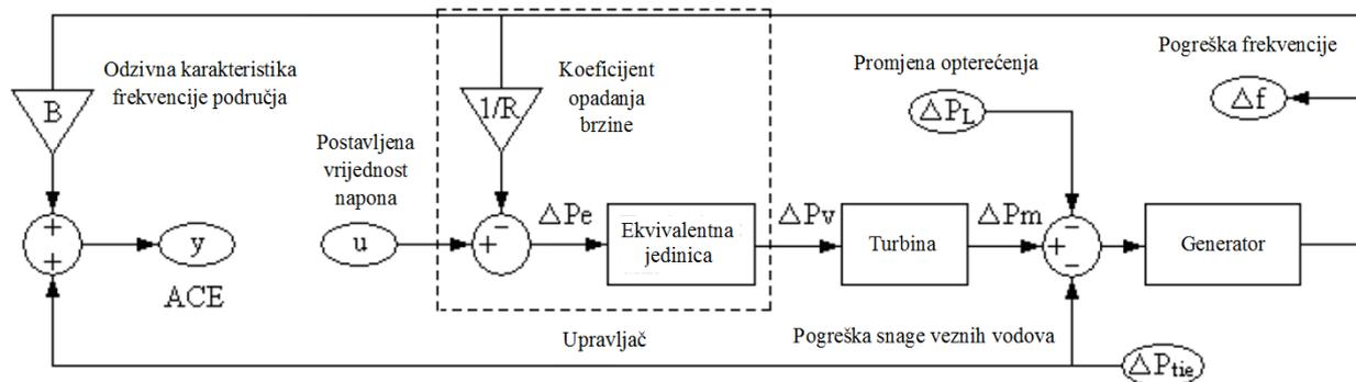
Slika 4.3. Dinamički model generirajućih jedinica jednog područja[13]
