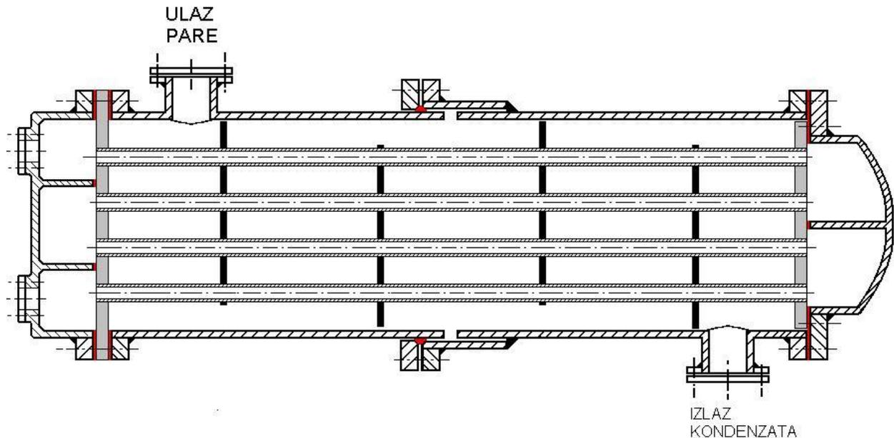
**Slika 8. Presjek kondenzatora, [1].**
