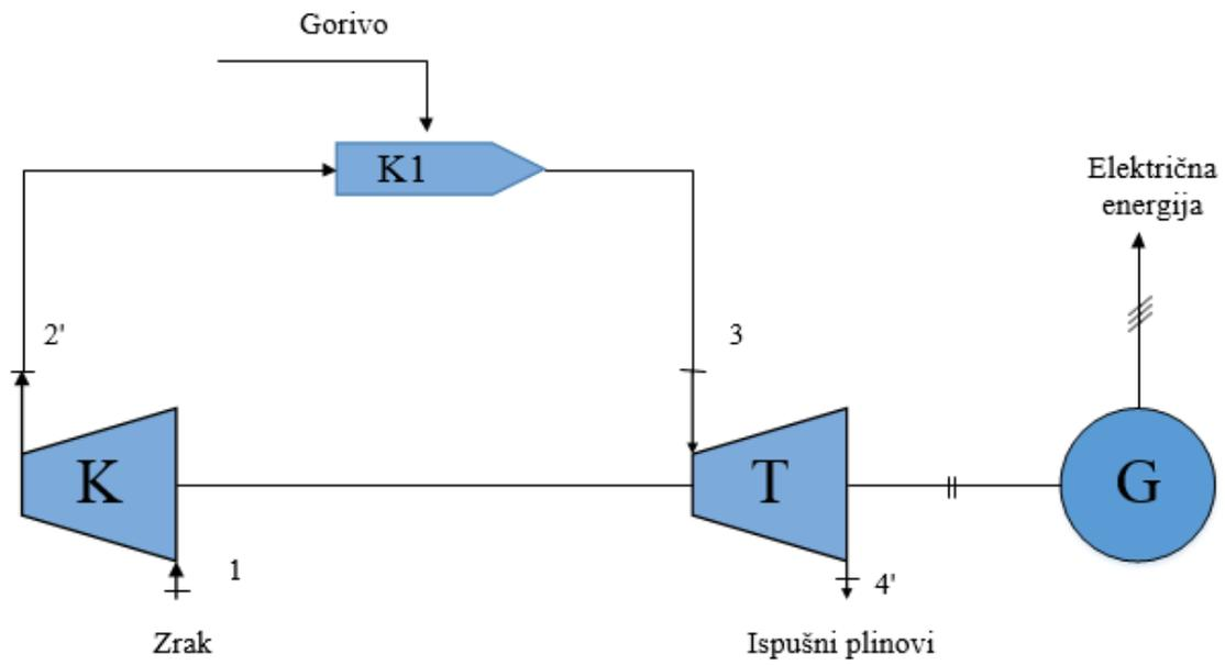
**Slika 1. Osnovni plinsko-turbinski proces**
