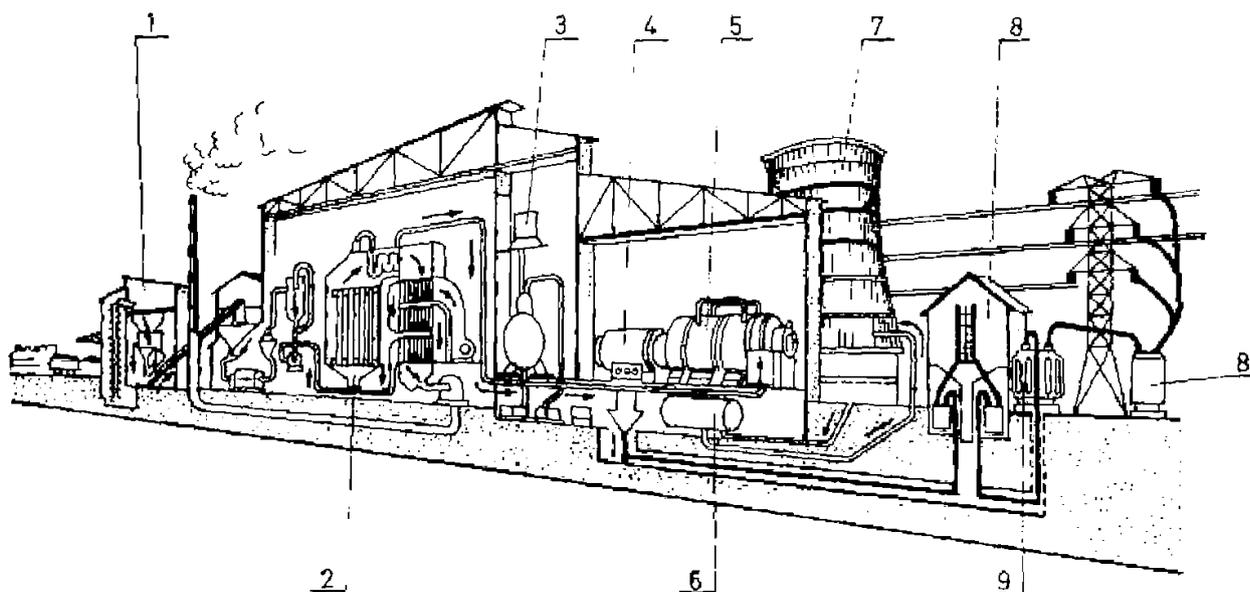
**Slika 7. Osnovna oprema parne termoelektrane: 1 – priprema goriva (mlinovi), 2 – parogenerator, 3 – priprema vode za parogenerator, 4 – električni generator, 5 – parna turbina, 6 – turbinski kondenzator, 7 – rashladni toranj, 8 – rasklopno postrojenje, 9 – visokonaponski transformator, [3]**
