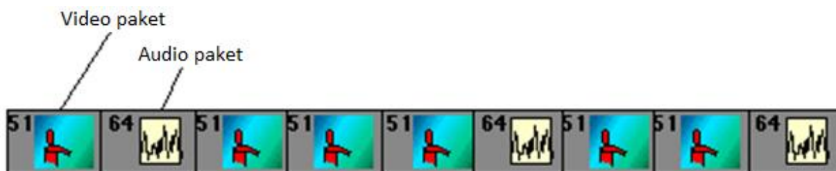
Slika 2.2 Izgled jednostavnog MPEG2 prijenosnog toka [4]
