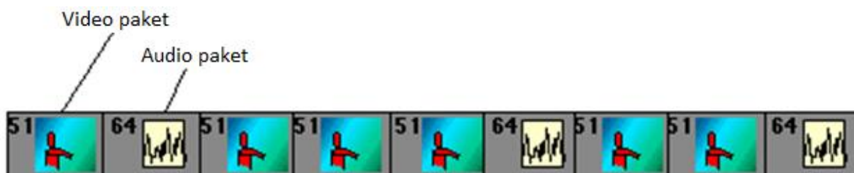
Slika 2.2 Izgled jednostavnog MPEG2 prijenosnog toka [4]
