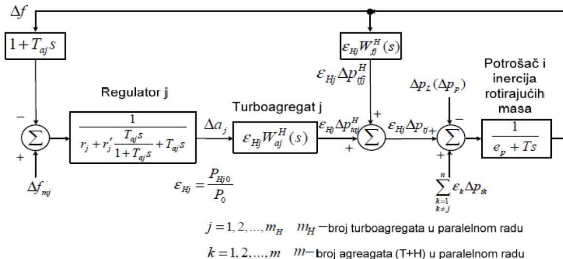
Slika 2.2. Struktura blokovska shema turboagregata u slučaju paralelnog pogona s elektroenergetskim sustavom [3].
