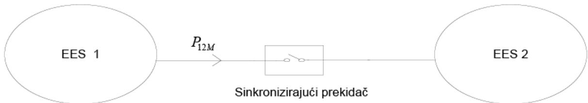
Slika 2.5. Nadomjesna shema dva izolirana elektroenergetska sustava koji se sinkroniziraju [7]
