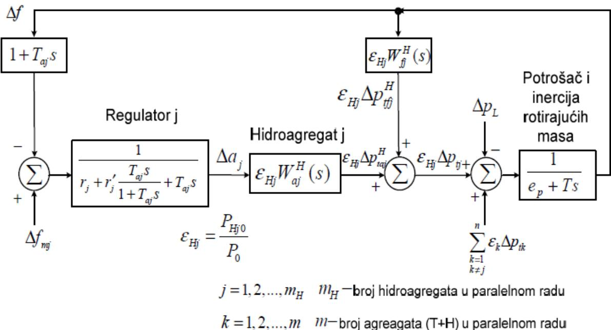
Slika 2.3. Strukturalna blokovska shema hidroagregata pri paralelnom radu na elektroenergetski sustav [3].
