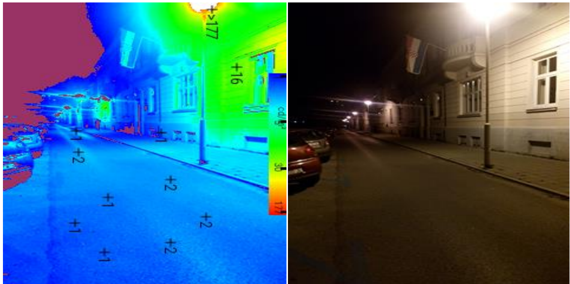
Slika 5.20. Prikaz sjajnosti kolnika u različitim točkama pomoću Photolux-a
