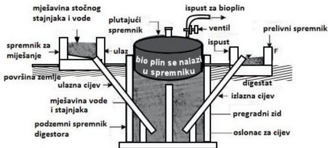
Slika 2.14. Digestor s plutajućim spremnikom na vrhu
