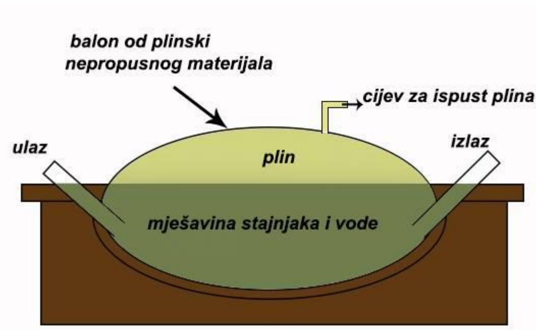
Slika 2.12. Pojednostavljeni prikaz digestora sa balonom na vrhu
