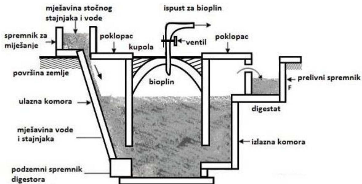
**Slika 2.13.** Digestor s fiksnom kupolom na vrhu
