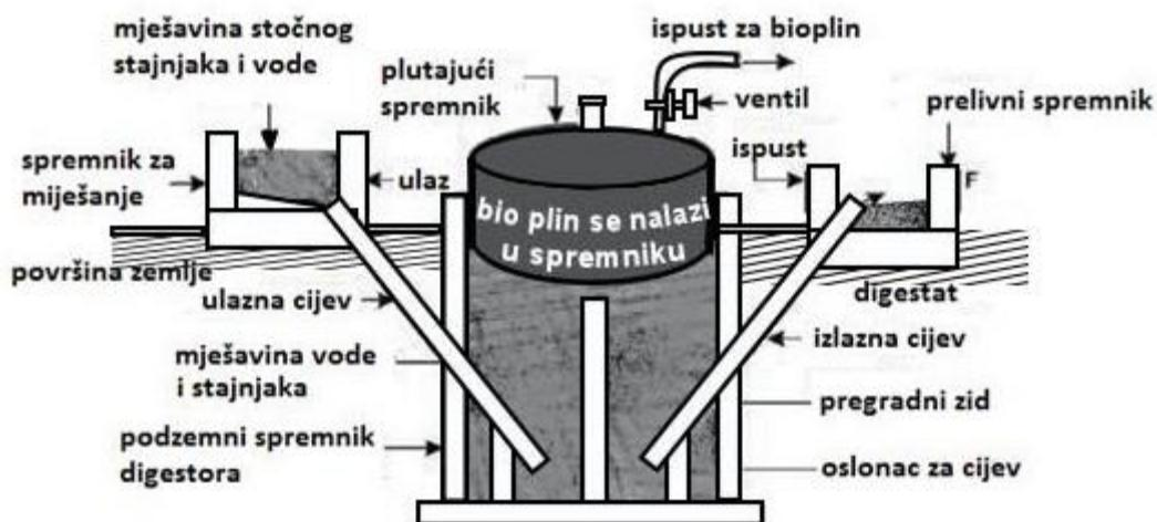
**Slika 2.14.** Digestor s plutajućim spremnikom na vrhu
