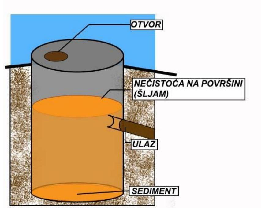
**Slika 2.9.** Pojednostavljeni prikaz spremnika tekuće sirovine
