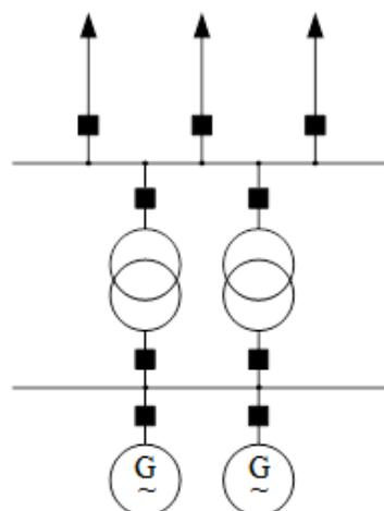
**Slika 2.18.** Shema spoja generatora na mrežu višeg napona
