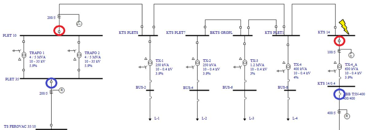
**Slika 6.3.** Trofazni kratki spoj na 10 kV sabirnicama u KTS 14
