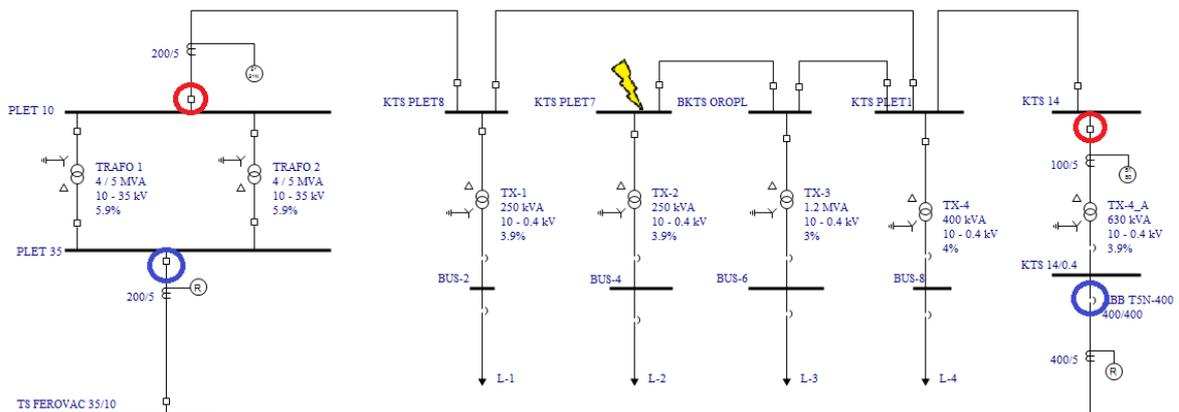
**Slika 6.5.** Trofazni kratki spoj na 10 kV sabirnicama u KTS 7
