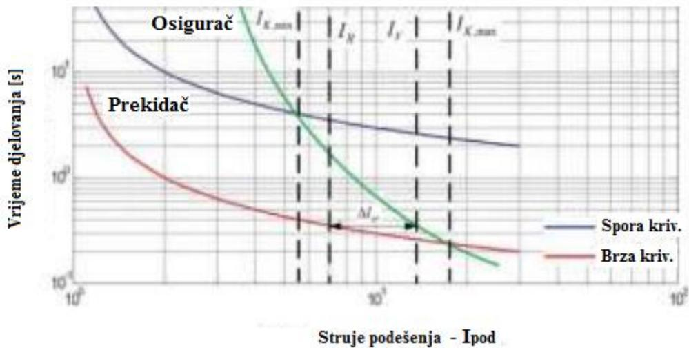
**Slika 3.3.** Princip koordinacije zaštite nakon priključenja generatora [17]
