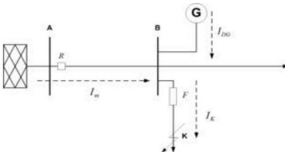
**Slika 3.2.** Kvar u distribucijskoj mreži štićen osiguračem, nakon priključenja generatora [17]
