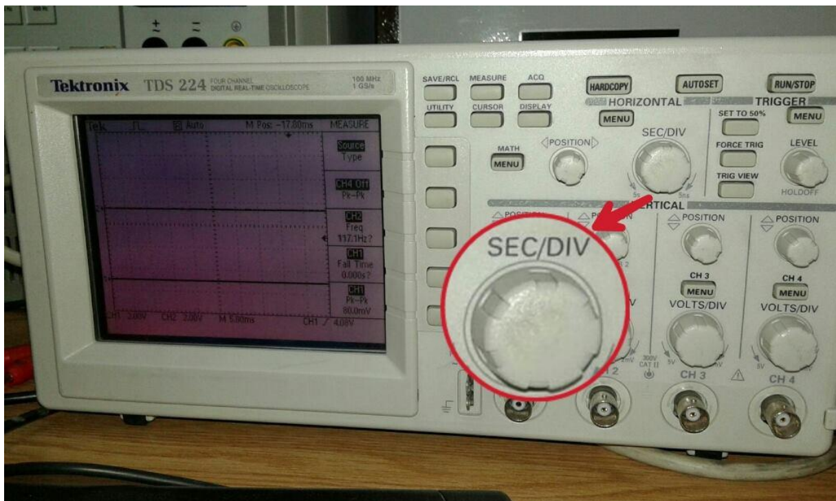
Sl. 3.1. Kontrola na osciloskopu Tektronix TDS 224 kojim reguliramo vremensku bazu
