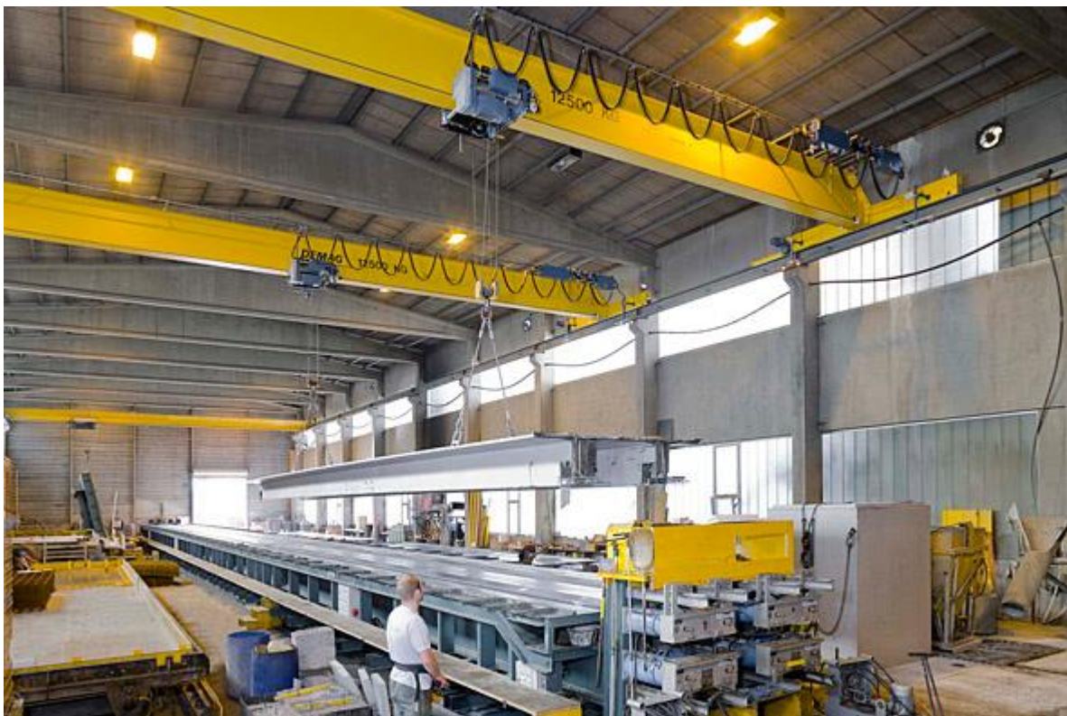
Slika 3.5. Primjer stropne teretne dizalice u tvornici [10].
