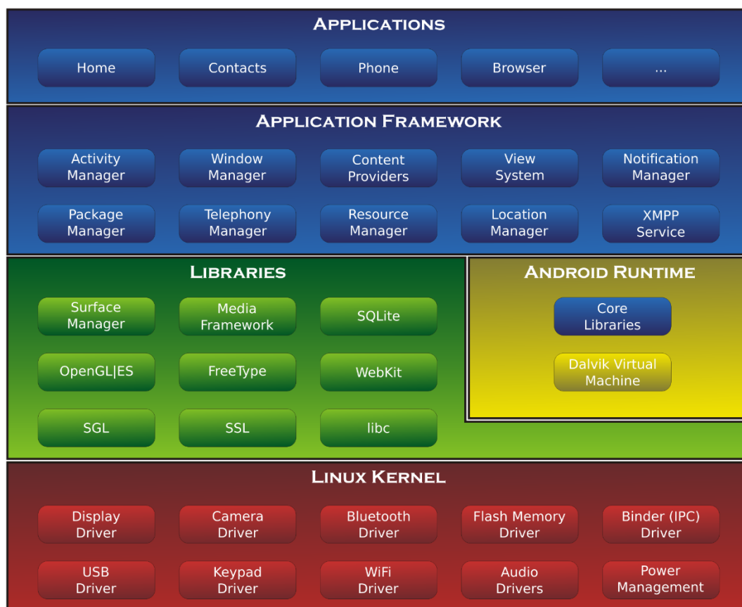
Sl. 2.2: Arhitektura Android sustava (izvor: http://simpledeveloper.com ).
