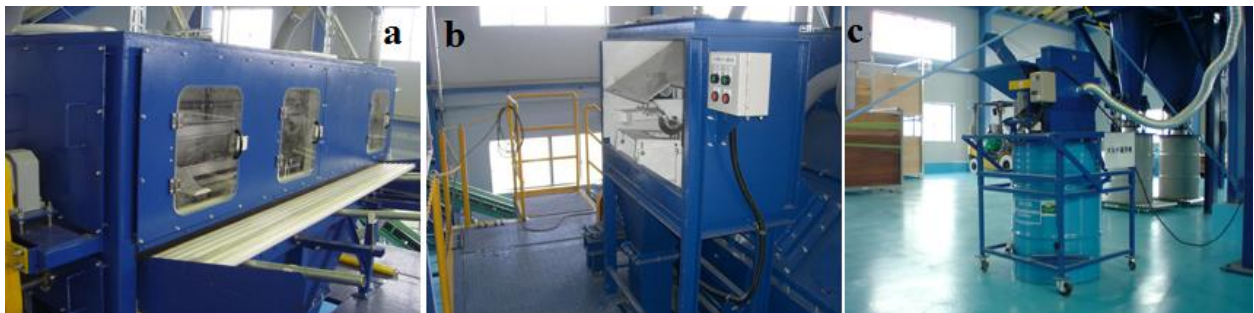
Slika 4.6. Različite jedinice postrojenja za postavljanje rasvjetnih tijela i drobljenje; a) jedinica za fluorescentne cijevi, b) jedinica za fluokompaktne žarulje, c) jedinica za ostale tipove žarulja
