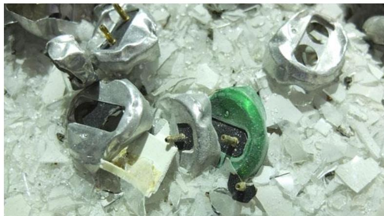
Slika 4.5. Zdrobljeni materijal u bačvi dobiven „crusher“ uređajem [22]
