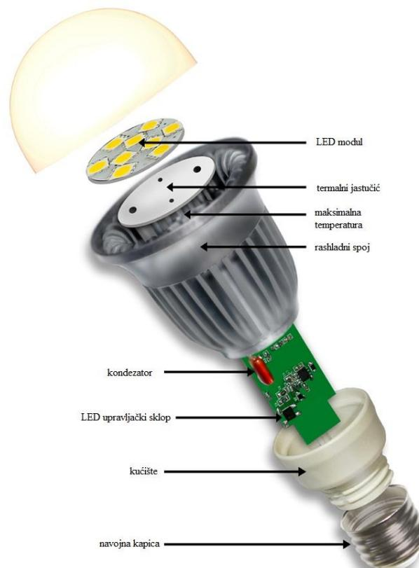
**Slika 2.5.** Materijalna struktura LED žarulje [9]
