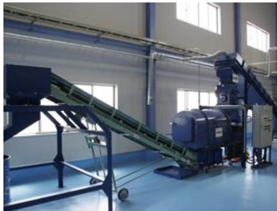
Slika 4.11. Jedinica postrojenja za odvajanje metala, plastike i stakla
