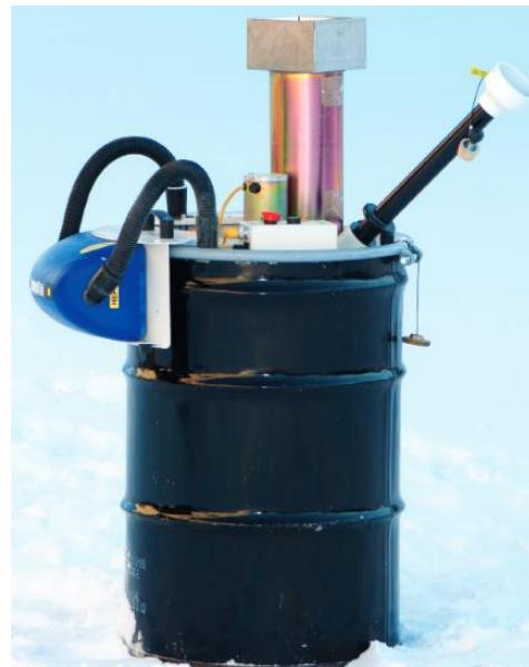
Slika 4.4. „Crusher“ uređaj za recikliranje fluorescentnih cijevi
