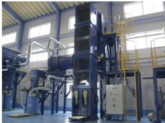
**Slika 4.7.** Jedinica postrojenja za odvajanje fosfornog praha sa živom od krutog materijala
