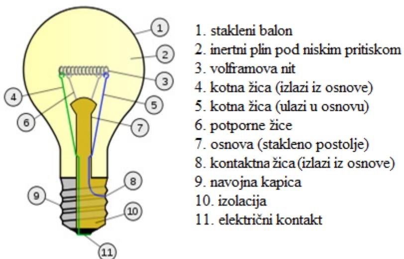
**Slika 2.1. Materijalna struktura standardne žarulje s užarenom niti [3]**
