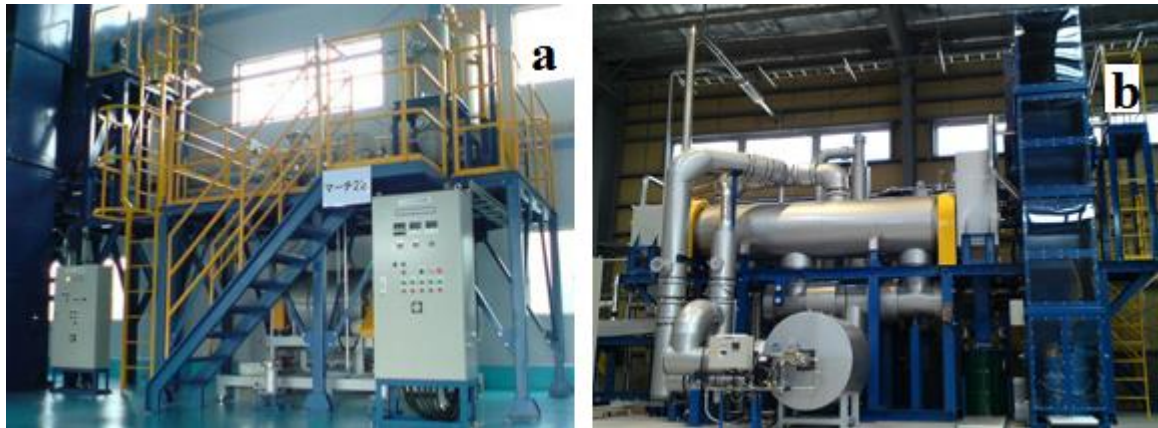
Slika 4.9. Centralne jedinice postrojenja za: a) sakupljanje žive iz fosfornog praha, b) sakupljanje žive iz krutog materijala
