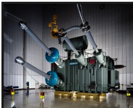
Slika 2.20. HVDC Pretvarački transformator [9]
