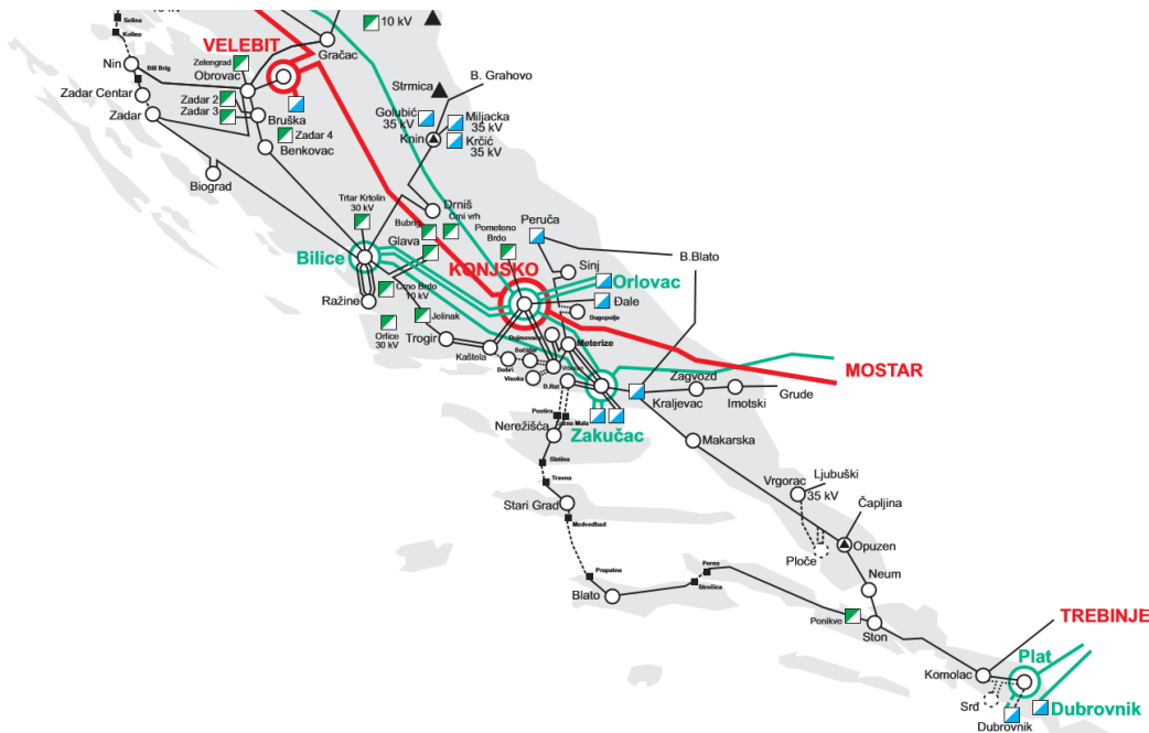
Slika 6.1 Shema elektroenergetskog sustava Dalmacije [22]
