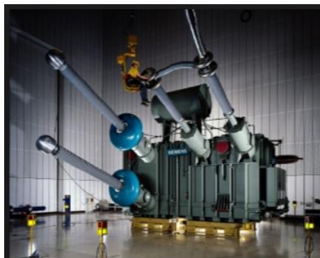
Slika 2.20. HVDC Pretvarački transformator [9]
