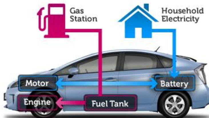
*Slika 2.3 Prikaz punjivog hibridnog električnog automobila [3]*
