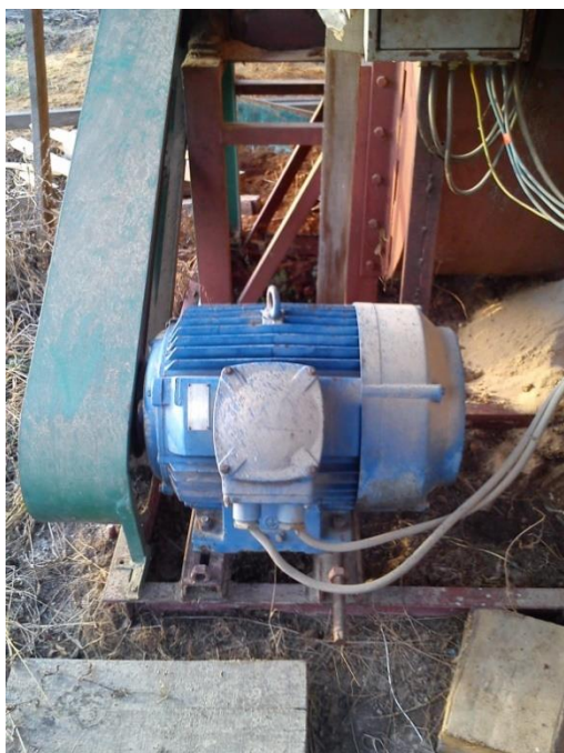
Slika 6.5. Elektromotor usisnog sustava
