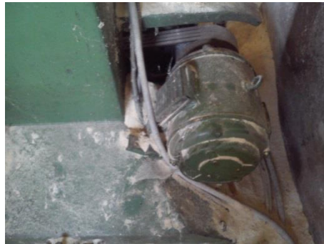
Slika 5.5. Elektromotor koji pogoni pilu stroja
