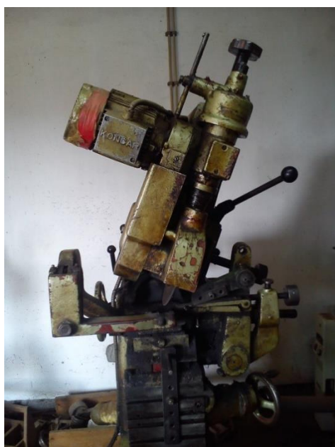
Slika 7.1. Stroj za oštrenje pila
