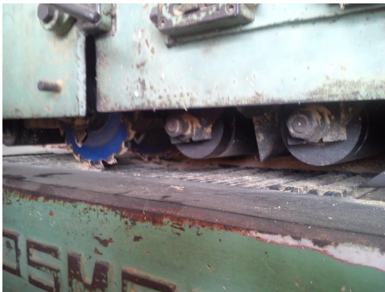
Slika 4.17. Mehanizam višelisne pile
