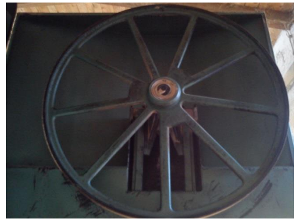
Slika 5.2. Kolut za navođenje pile
