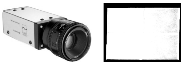
a) B/W line scan camera / Crno-bijela linijska kamera b) Acquired image (tile outline only / Snimljena slika (samo konturni obris pločice)
